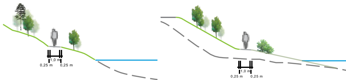
Figur 3 viser eksempler på tråkk på eksisterende terreng (til venstre) og på slak fylling (til høyre).
