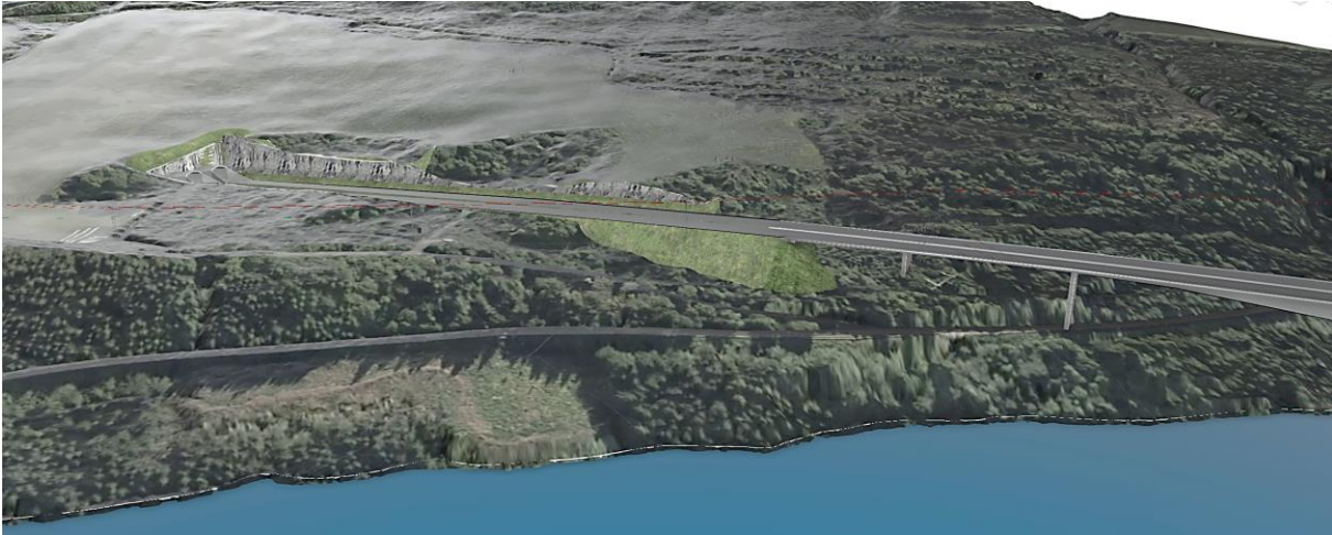
Figur 5-121 Bilde fra modell som viser påhuggsområde, forskjæring og fylling før E6 går over på bru til høyre i bildet.
