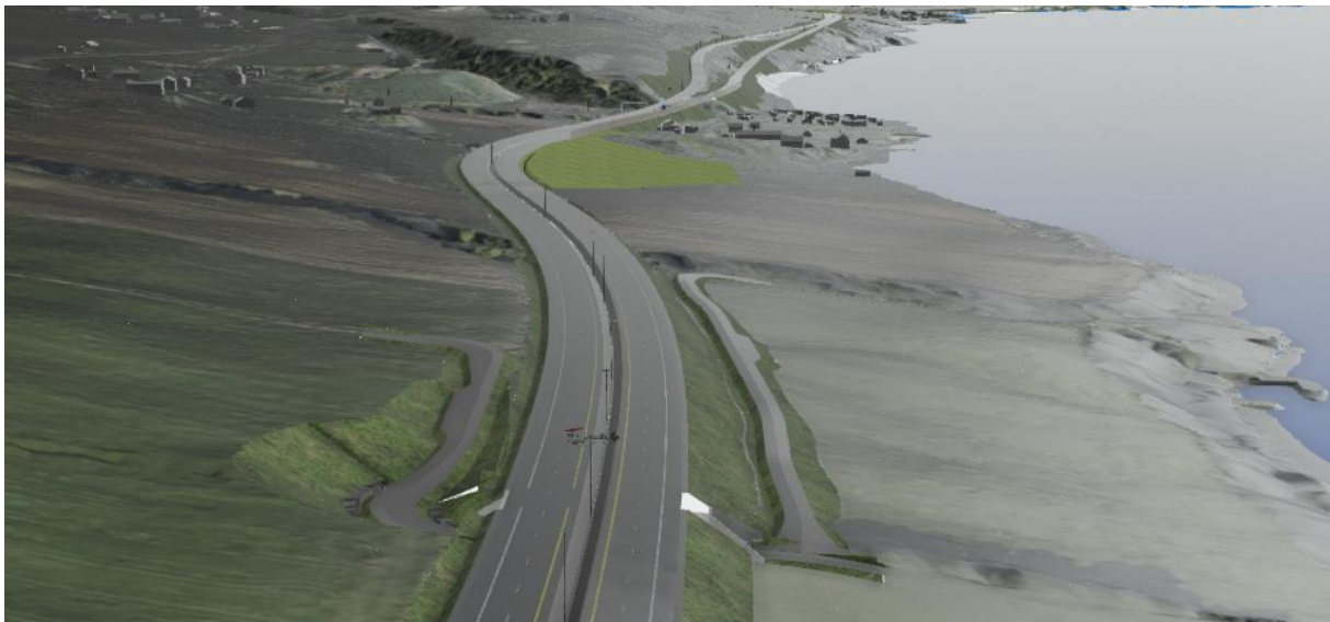
Figur 5-15 Bilde fra modell som viser Rogne kulvert. Lange tilførselsveier medfører er bredt veirom.
