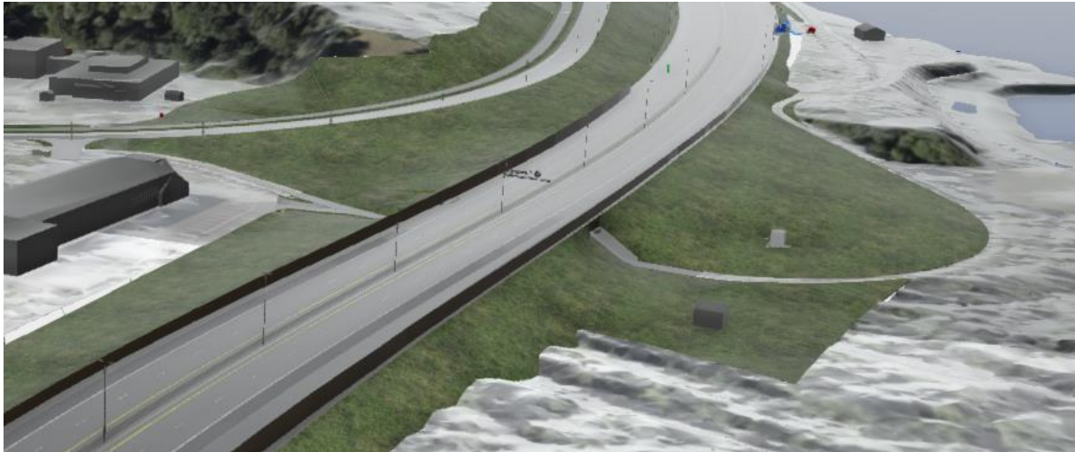
Figur 5-49 Bilde fra modell som viser E6 forbi sentrum og friområde på Vingromdammen. Ny veilinje går noe høyere enn dagens E6 og kommer nærmere Mjøsa forbi Vingromdammen.
