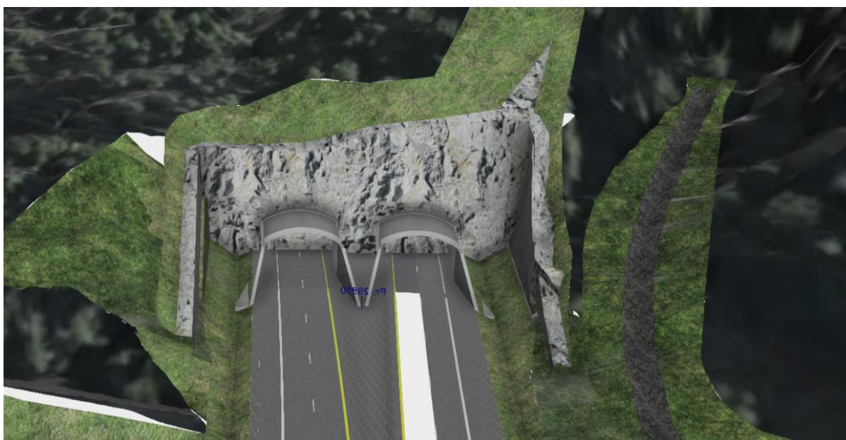
Figur 7: Forskjæring/påhugg Trosset. Portaler er tatt med for skala. Grøften til høyre på bildet er omlegging av Kollefallbekken som kommer ned rett nordvest for forskjæringen. Klipp fra BIM-modell 18.03.2021
