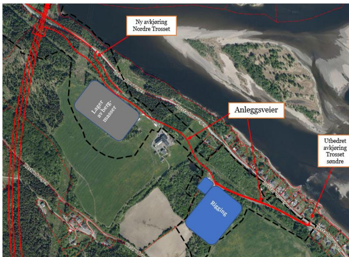
Figur 8-9. Midlertidig mellomlager på Trosset, sør for portalområdet.
