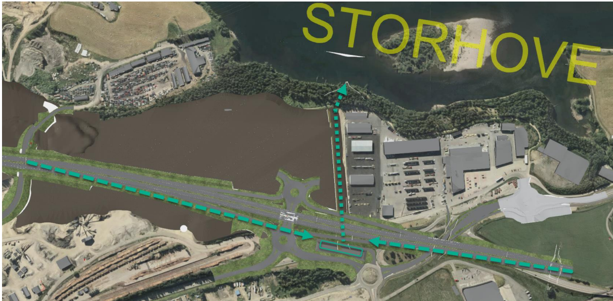
Figur 8-2. Prinsipp for oppsamling av overvann fra vei til basseng på Storhove
