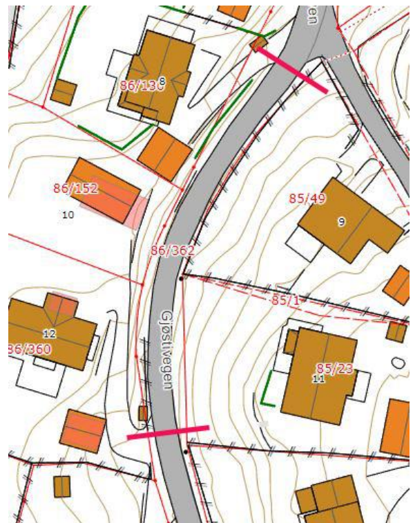
Kartutsnitt 7 – Strekning langs Gjøstivegen med manglende møtesikt
