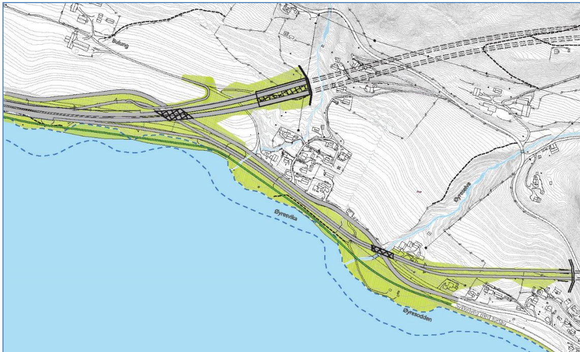
Figur 5-20 Kryss i Øyresvika for alternativ II-C-2-D, adkomst til byen i separat tunnel under Vingnes fra Riselandet
