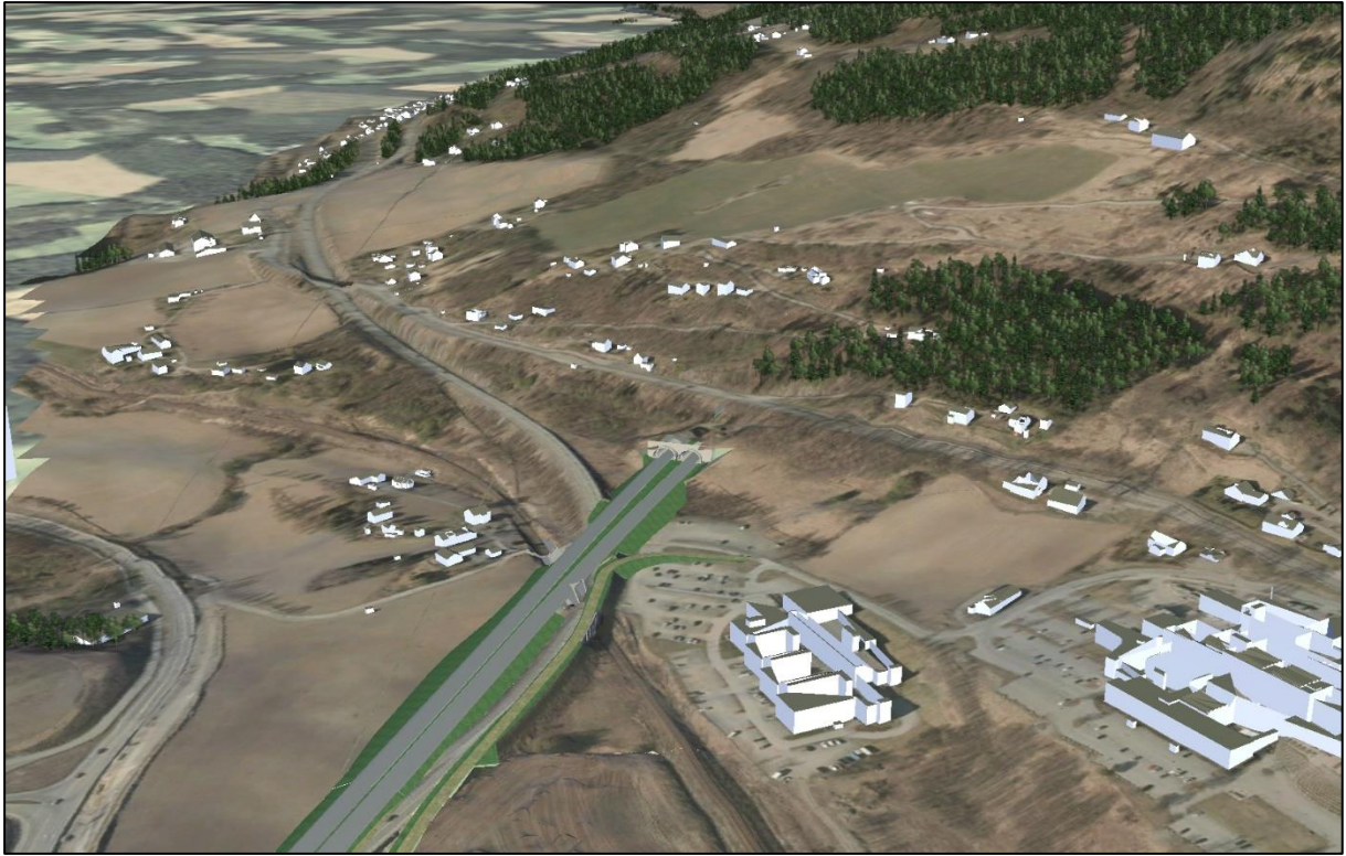
Figur 5-23 Tunnelpåhugg ved Storhove rett nedenfor fv 312. Høgskolen til høyre i illustrasjonen.
