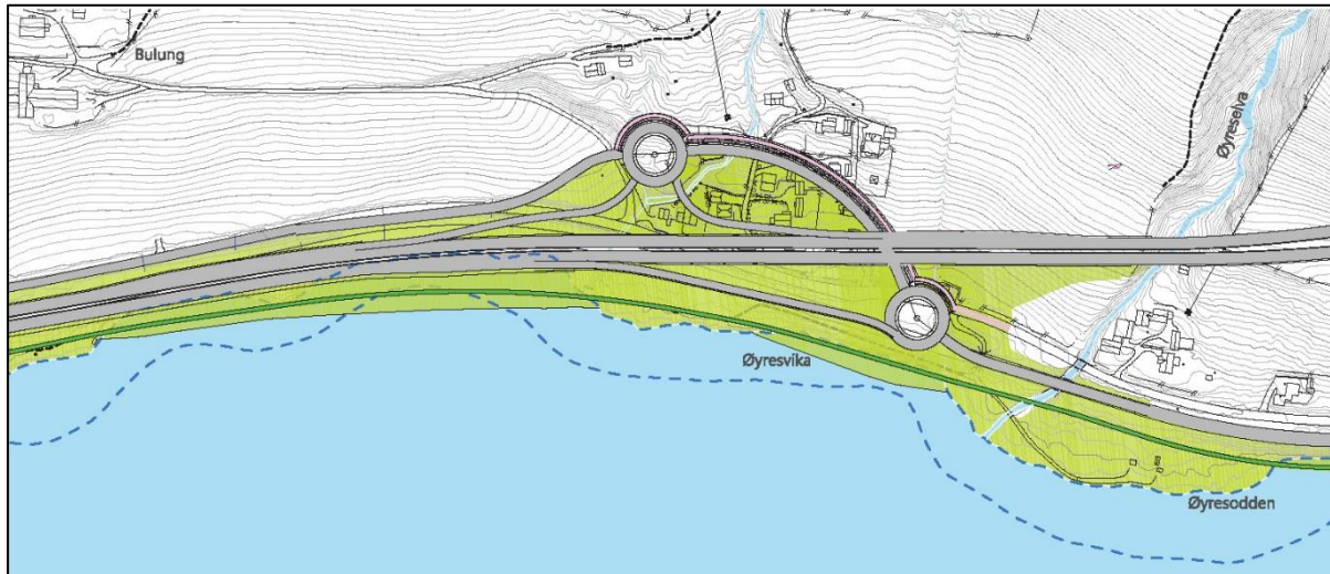
Figur 5-6 Kryss med 3 ramper (3/4 kryss)
