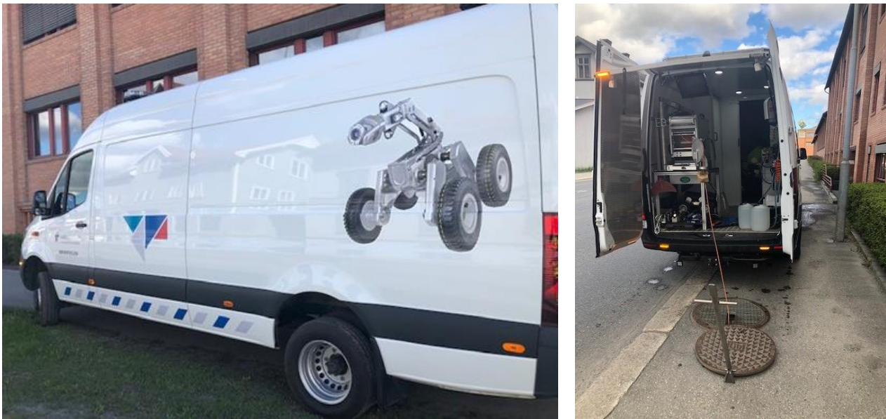
Figur 39 Kamerabil med utstyr for TV-inspeksjoner er både et nødvendig og svært nyttig arbeidsverktøy
