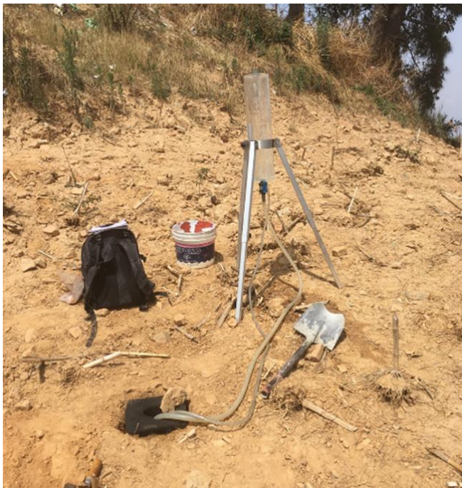
Figur 55 Grunnundersøkelser i felt for å kartlegge jordmassenes evne til å motta avløpsvann (foto: Øystein Fure Mæhlum) og skisse av infiltrometer (Norsk Vann, rapport 178/2010)
