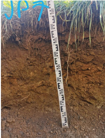
Figur 2-9. Jordprofil tatt på gården Elvestad. Tykkelse A-sjikt 40-45 cm, relativt lite tydelig overgang til B-sjikt. B-sjiktet har relativt mye røtter, det er ikke registrert et nytt tydelig sjikt under. Profilet viser at fargen på jorda blir lysere nedover i profilet. Totalt gravd 1 meter.
