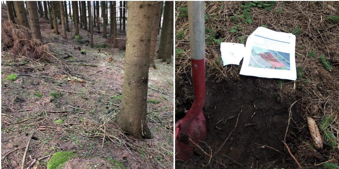
Figur 5-10. Felt 19 på gården Hellerud. Området er skogkledd med lite undervegetasjon og en del større stein i dagen. Det er ikke observert fjell i dagen. Jordprofil fra felt 19. Jorda framstår som mulig å dyrke opp uten at man tilfører store mengder eksisterende matjord fra permanent beslaglagte arealer. Går over i et noe lysere jordsmonnssjikt etter ca. 35-40 cm.
