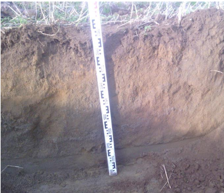
Figur 2-16. Jordprofil fra gården Lekshus. Tykkelse A-sjikt 20 cm, B-sjikt er lite utviklet og framstår som ren sand.
