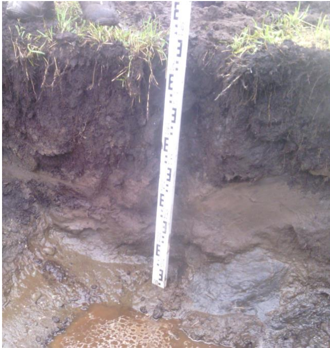
Figur 2-17. Jordprofil fra gården Mo. Tykkelse på A-sjikt mellom 40-45 cm. Lite tydelig B-sjikt, da dette framstår som sandig og svært våt silt.
