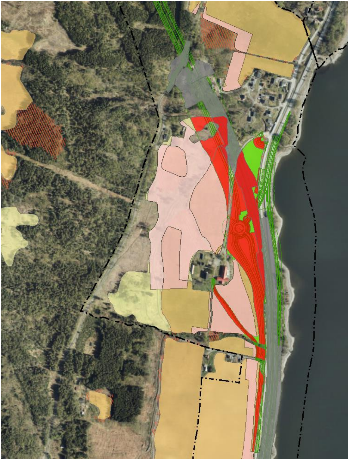
Figur 5-27. Øyresvika, trekvart kryss. Permanent arealbeslag (rød flate av dyrka mark (gule flater) fra vei, kryss og landbruksunderganger. Rød skravur viser dyrkbare arealer. Grønn flate viser antatt tapt som følger av lite restareal eller vanskeligere driftsforhold.
