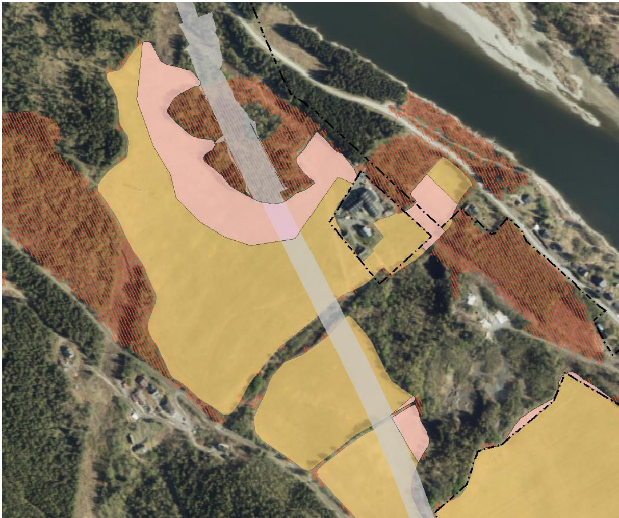
Figur 5-35. KDP-linjen ved Nordre Trosset. Det vil bli betongtunnel i starten med antatt mulighet for reetablering av dyrka mark over denne etter er tunnelen er ferdig bygget.
