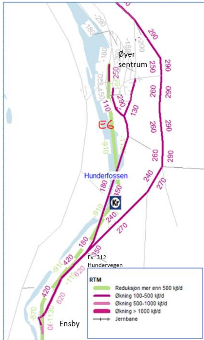
Figur 2.2-4: Endring i ÅDT i 2022 som følge av bompenger på E6 Lillehammer - Øyer.
