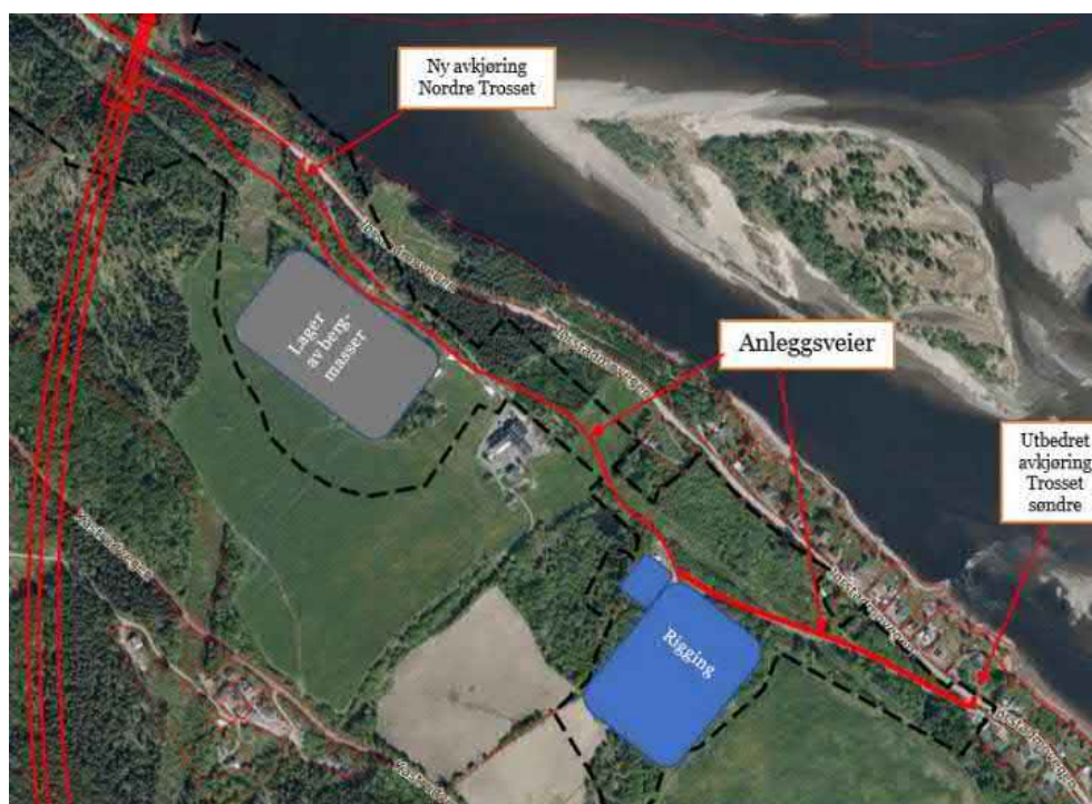
Figur 2 - Trosset - deponier og anleggsarbeid i byggeforbudsbelte og nært ved Statnetts 300 kV luftledning. Må avklares mellom tiltakshaver og Statnett
