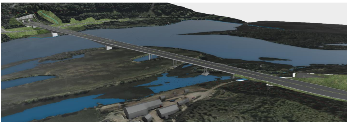
Figur 1-14. Lågen bru i justert linje, fritt frembygg-bru
