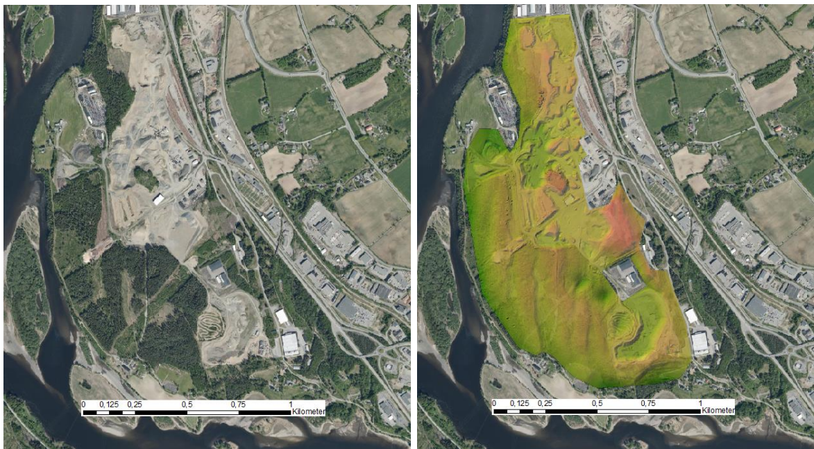
Figur 4-7 Venstre: Flybilde over Hovemoen Høyre: Oversikt over terrengdata som er benyttet i beregning av areal/volum som ikke er beslaglagt i dagens tilstand. Lokale veier ligger innenfor arealet. (Kilder: www.norgebilder.no ; www.hoydedata.no )
