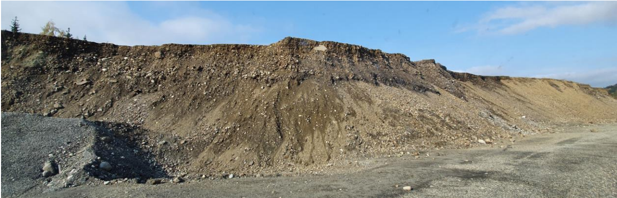
Figur 4-4. Grus som ligger i midtre del av uttaksområdet med sortert sand, grus og stein. Det er tegn til lagdeling. Bildet er tatt sør for knuseverket.
