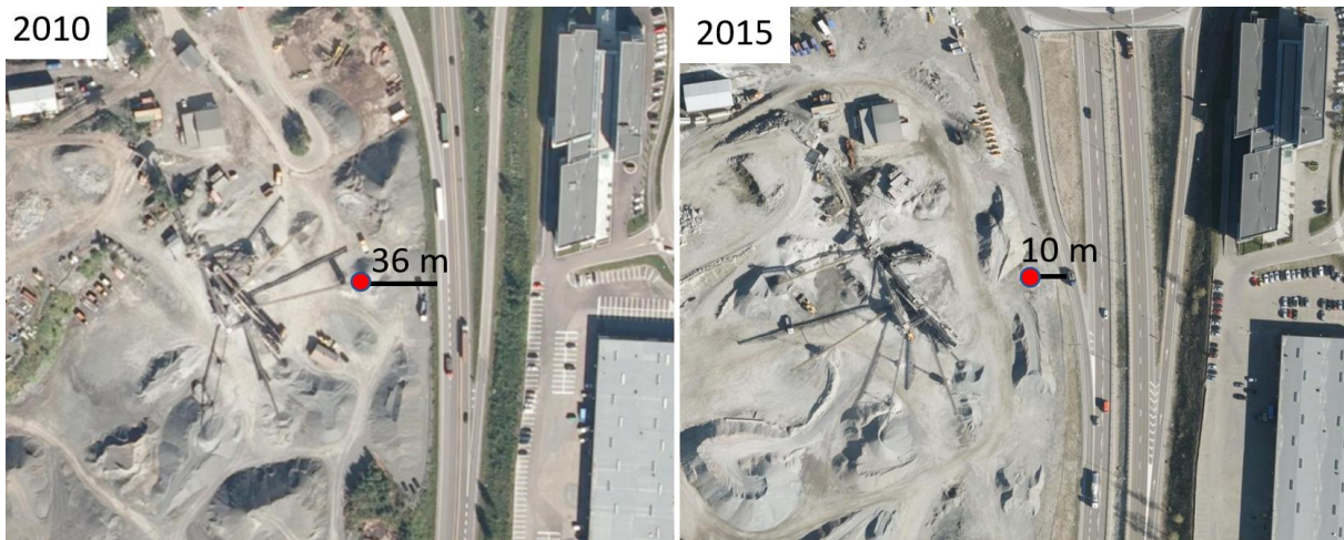
Figur 6-3 historiske flyfoto fra 2010 og 2015 som viser avstand mellom E18 og knuseverket på Fokserød pukkverk. Rød sirkel indikerer enden på transportbeltet i 2010, og hvor denne ville vært i 2015 om den ikke hadde blitt flyttet (kilde: kart.finn.no)
