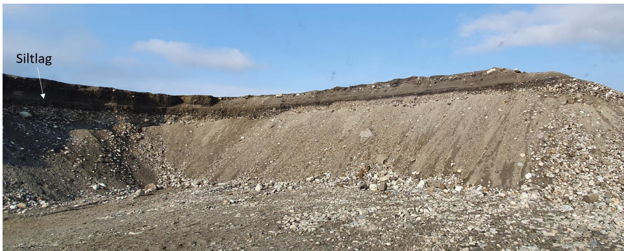
Figur 4-5. Grus som ligger i nordre del av uttaksområdet, her er det sortert sand, grus og stein. Forholdsvis høyt i avsetningen ligger et siltlag. Dette laget kan spores et stykke sørover, der overlagingen av grove masser øker mot sør. Bildet er tatt nord for knuseverket.
