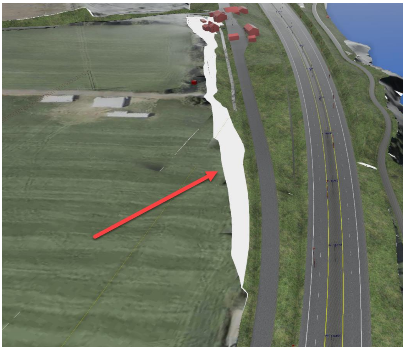
Figur 2. Mo – Lekshus. Justering av veiltaket har gitt noe mindre tap av dyrket mark. Effekten av oppstramming av tiltaket er vist som hvite felt. Rød pil indikere området der tapet av dyrket mark er blitt mindre.
