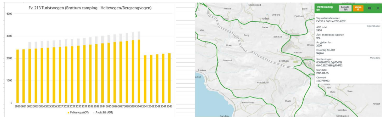
Figur V4.9 - Illustrasjon av avvist trafikk på lenken mellom Brøttum camping og Heltevegen/Bergsengvegen
