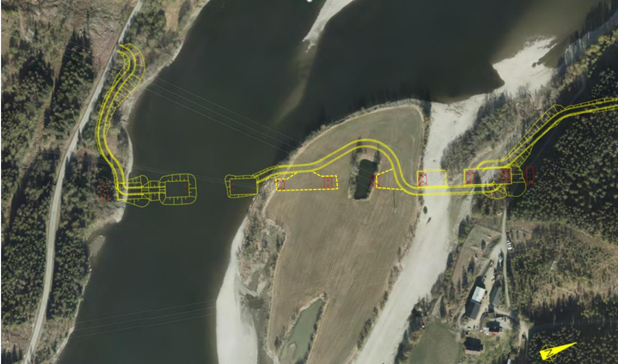
Figur 2-29 For å etablere søyler med tilhørende pilarer i hovedløpet må det etableres midlertidige fyllinger. Disse blir utført i to faser slik at innsnevringen av hovedløpet begrenses. Arbeidene utføres på vinterstid med lav vannføring
