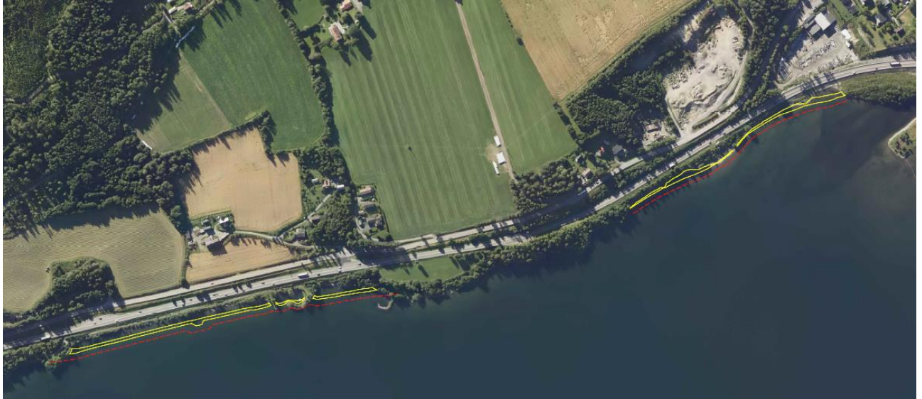
Figur 26. Anleggsbelte i sjø på strekningen Bakke camping – Vingrom markert med rød stiplet linje. Permanent fylling markert med gule linjer.
