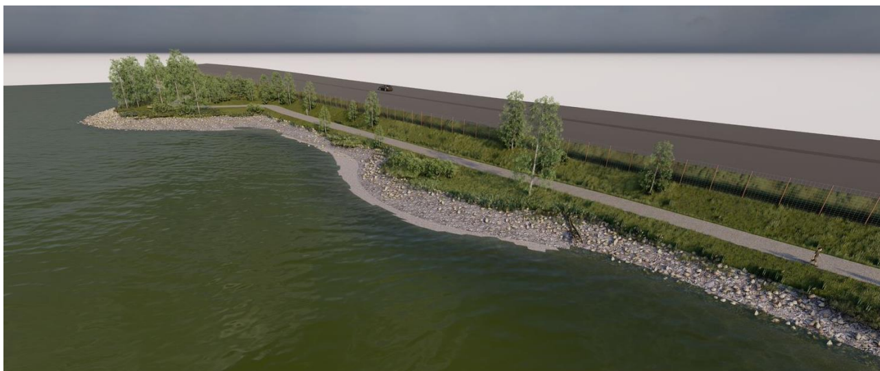
Figur 30. Strandlinjen gjenskapes med god variasjon og dynamikk - småskala buktning og kantvegetasjon.
