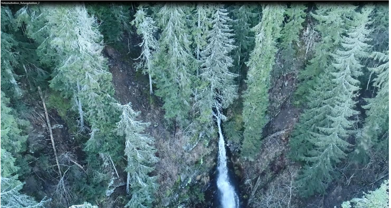
Figur 59 Utklipp fra dronefilm Bulungbekken, lenger oppstrøms Hovslivegen. Synlige nedbøyde, knekte trær og erosjon i løsmasser Filmet av AF Gruppen.
