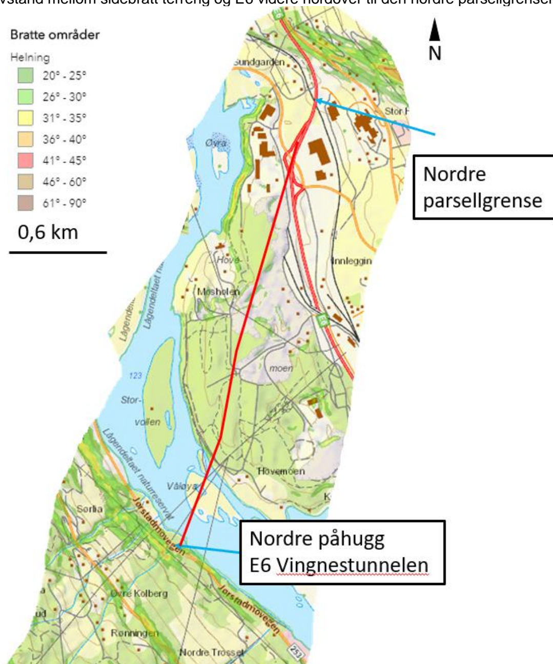
Figur 27 Kart med terrenghelning fra nordre påhugg og parsellgrense E6 [8]. Omtrentlig trasé til ny E6 er markert med rød linje.
