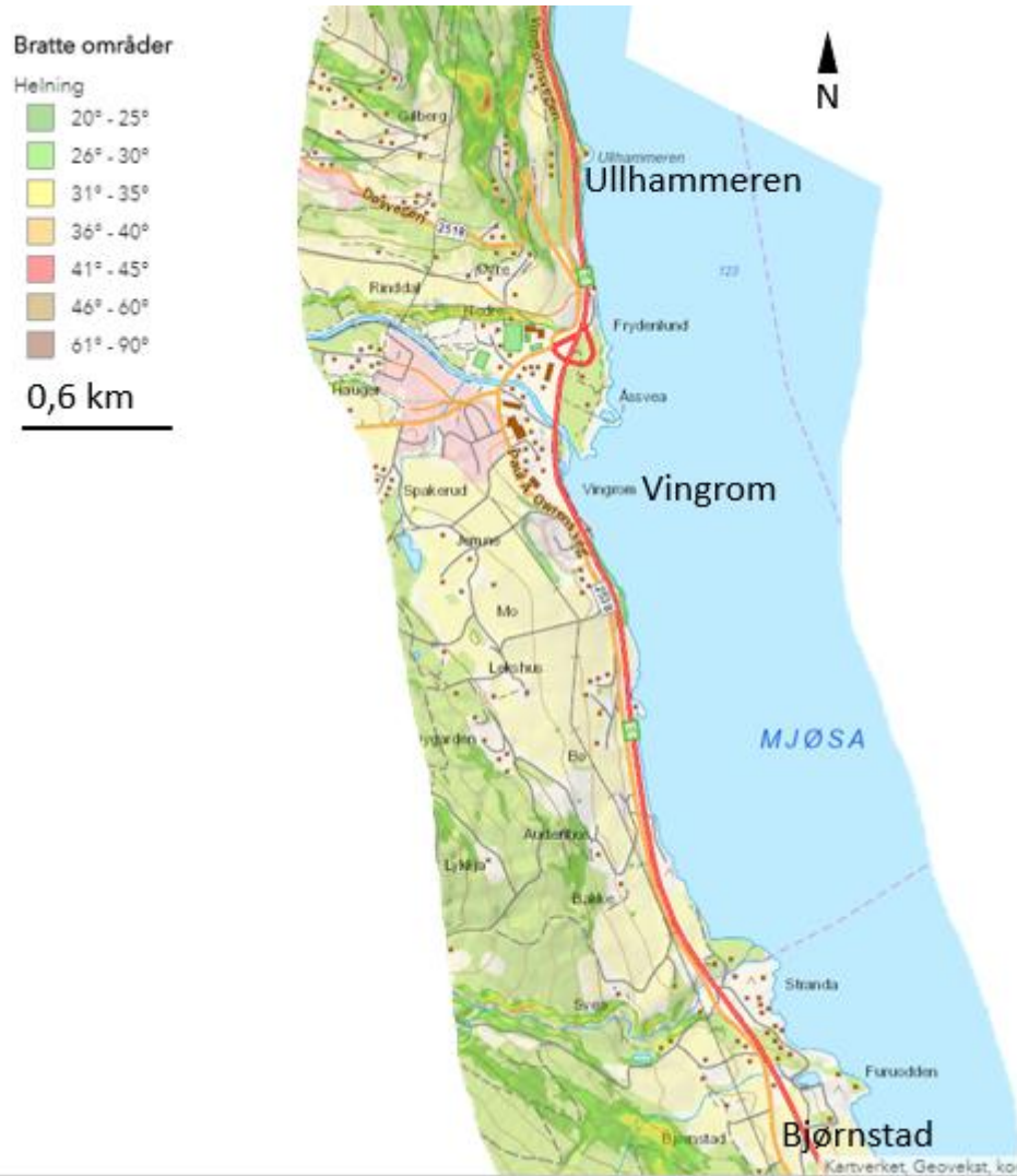
Figur 22 Kart med terrenghelning fra Bjørnstad til Vingrom [8]. Ny E6 følger trasé til eksisterende E6, merket med rød linje i figuren. Nytt kryss ved Vingrom er lokalisert ved Ullhammeren (Vingrom nord)
