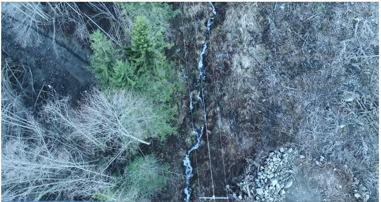
Figur 53 Utklipp fra dronefilm vest for Nordre Hov gård. Synlig erosjon, mindre utglidning til venstre og menneskeskapt fylling (stein) til høyre. Filmet av AF Gruppen.
