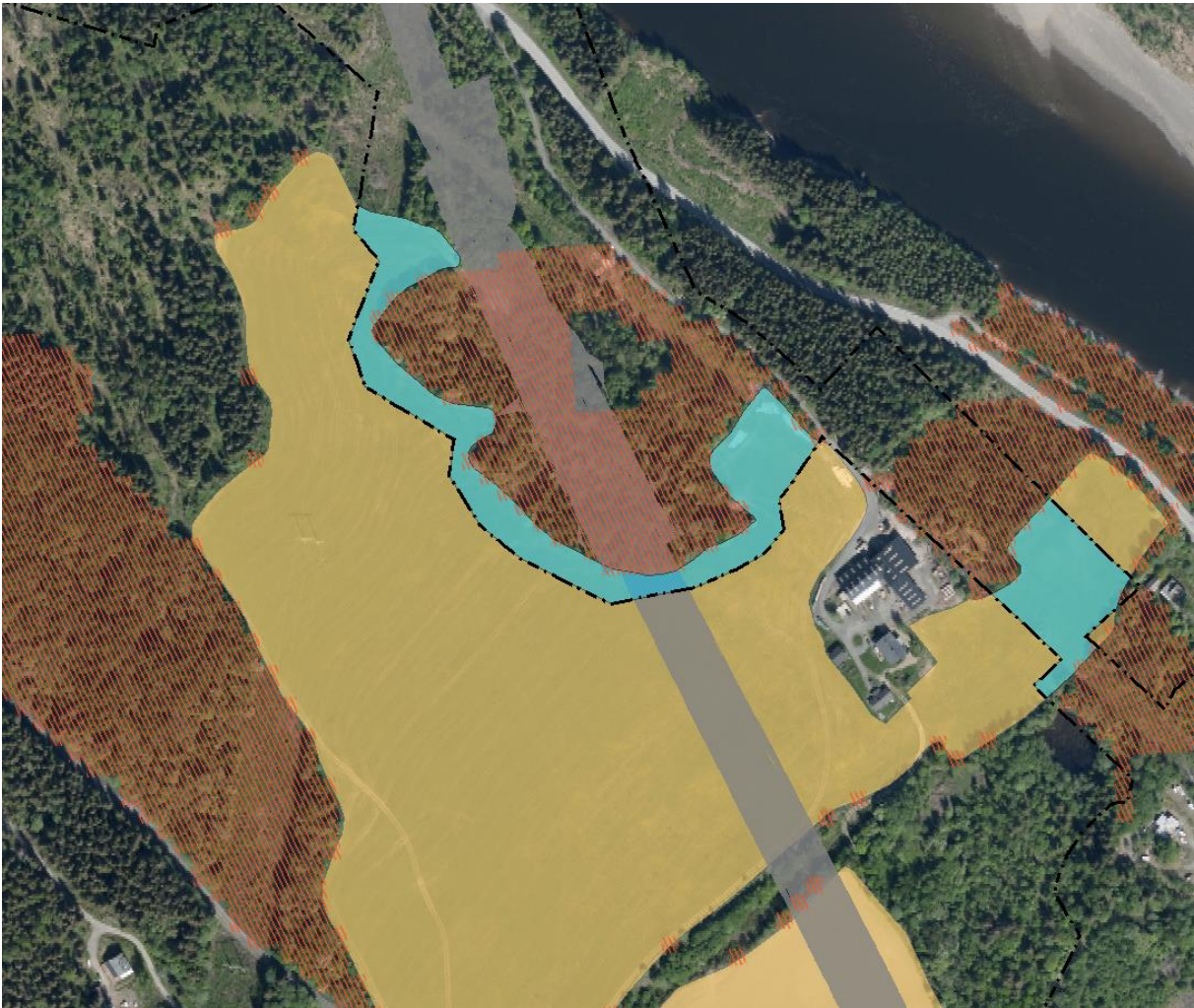
Figur 5-31. KDP-linjen ved Nordre Trosset. Det vil bli betongtunnel i starten med antatt mulighet for reetablering av dyrka mark over denne etter er tunnelen er ferdig bygget.
