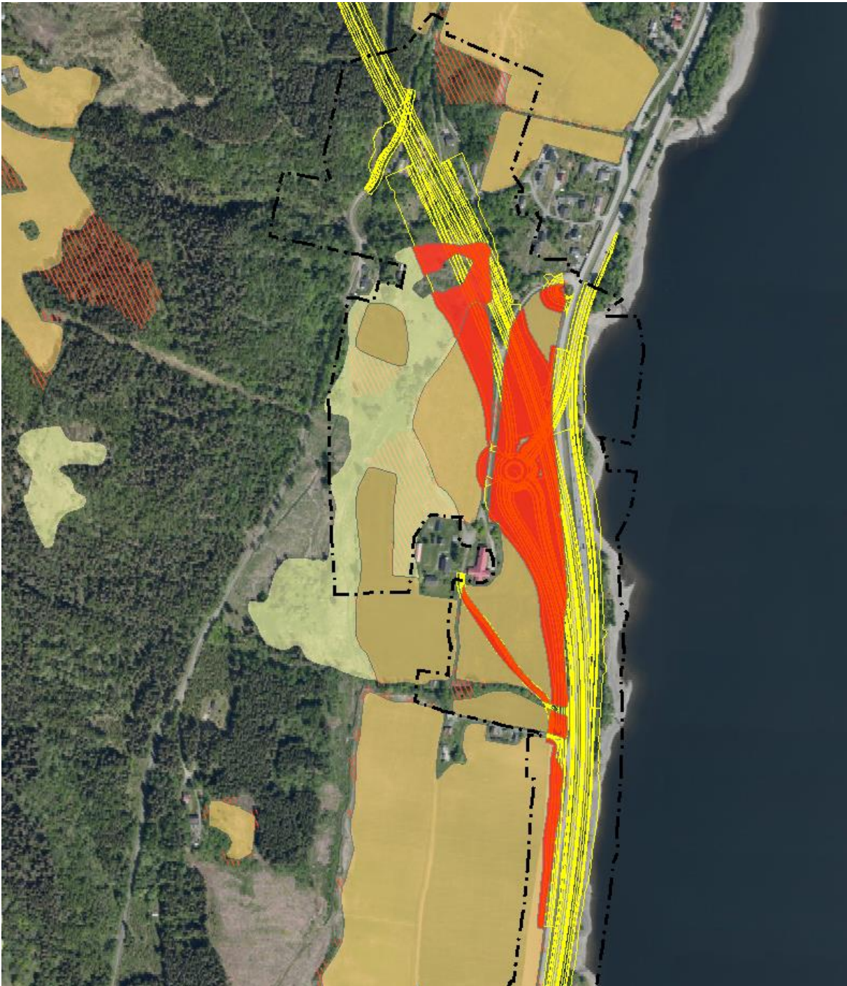
Figur 5-23. Øyresvika, trekvart kryss.. Trekvart kryss vil få større arealbeslag nord for Bulung, og større arealbeslag og driftsulempner knyttet til ny adkomstvei til gården. Permanent arealbeslag (rød flate) og midlertidig arealbeslag (lys blå flate) av dyrka mark (gule flater) for veiformål og annen veigrunn. Midlertidig arealbeslag er ikke vist på denne figuren, men blir om lag likt som for halvt kryss. Rød skravur viser dyrkbare arealer.
