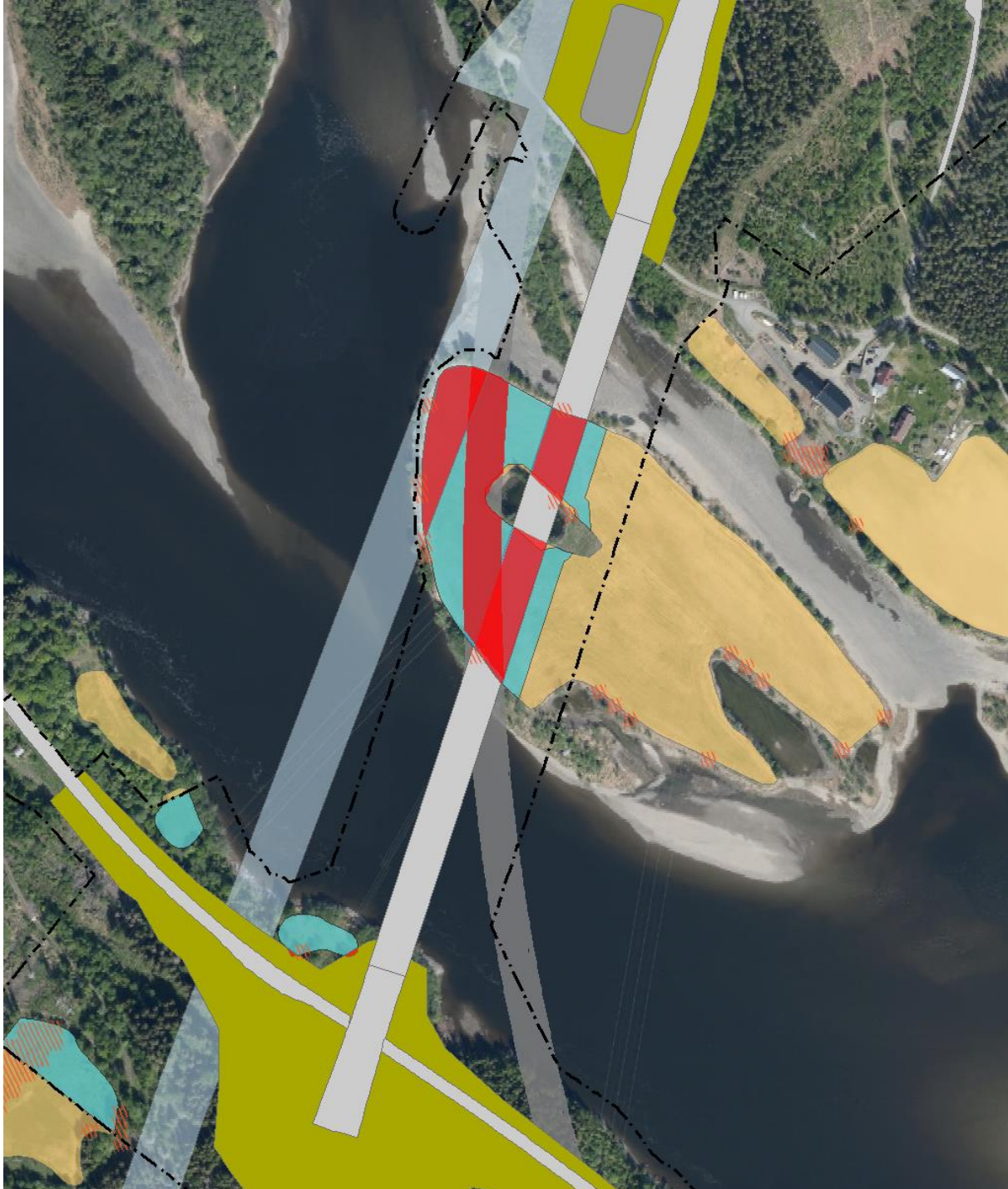
Figur 5-30. Arealpåvirkning direkte under bru (rød flate) og midlertidig anleggsområde (blå flater) av dyrka mark (gule flater) fra vei på bru. Rød skravur viser dyrkbare arealer. Påvirkning som regn- og lysskygge er ikke vist på kart.
