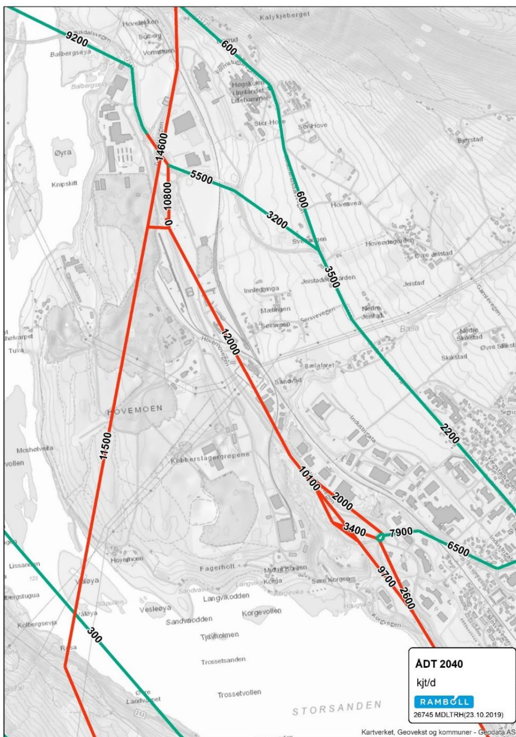
Figur 19 Avlastet E6 – Sannom - Hovemoen, detaljert ÅDT 2040 (RTM)
