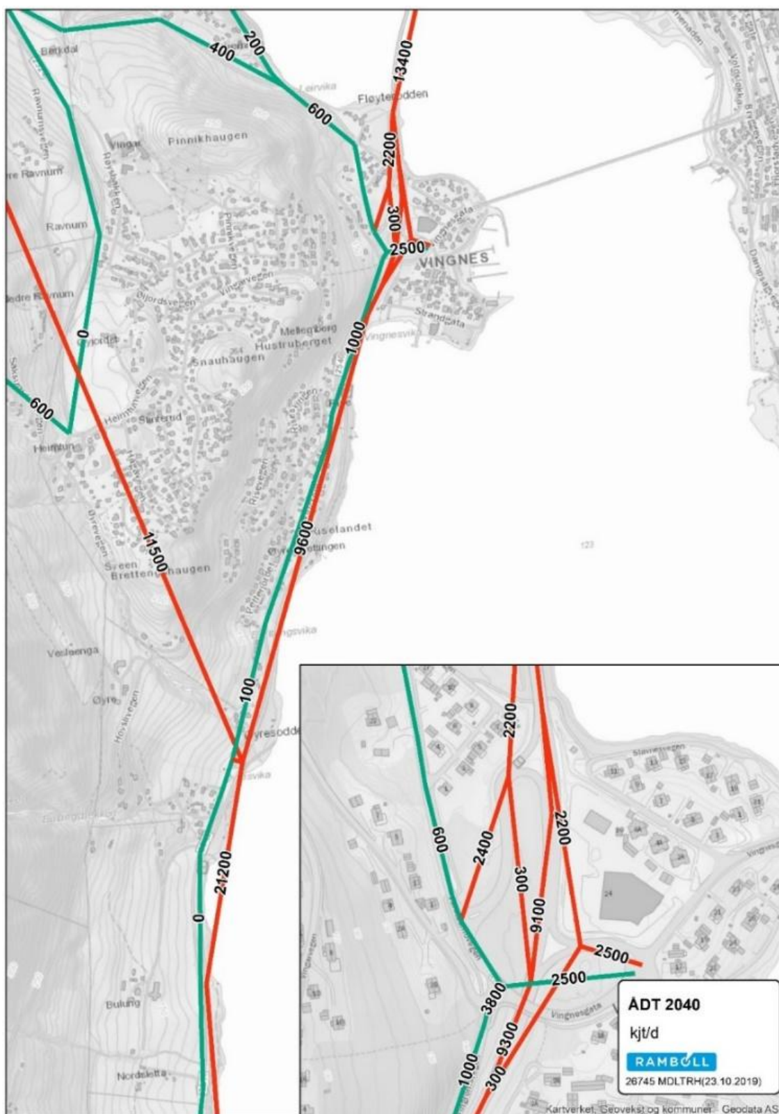
Figur 17 Avlastet E6 – Vingnes, detaljert ÅDT 2040 (RTM)
