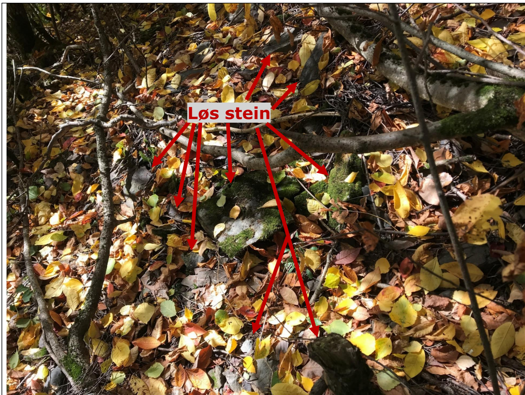
Figur 9. Parti B. Det er observert stein og blokk i skråningen ca. 3 m fra skjæringstopp. Se beskrivelse i kap. 3.
