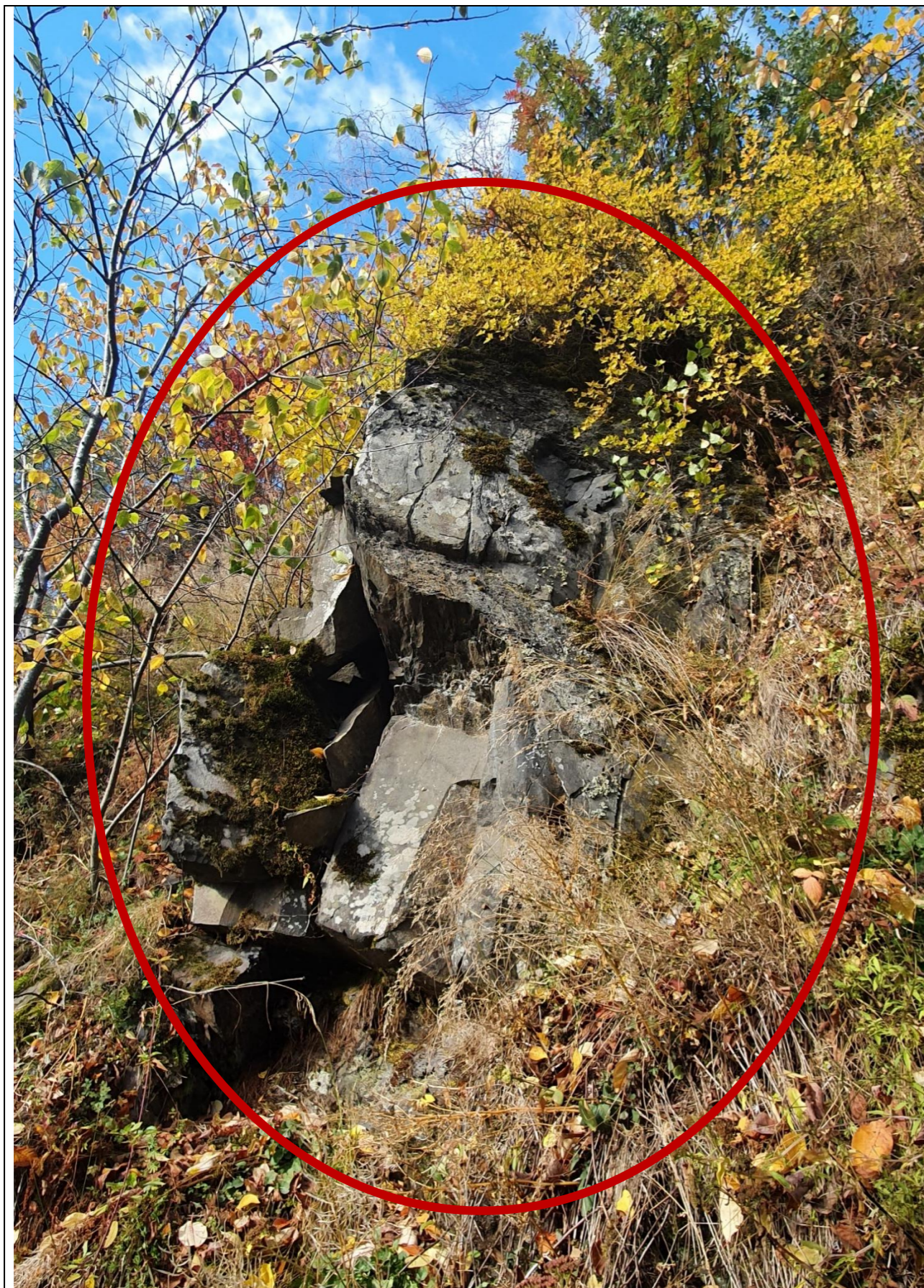
Figur 10. Parti B. To av flere større blotninger med usikrede blokker som potensielt kan føre til steinsprang (markert med røde ellipser).
