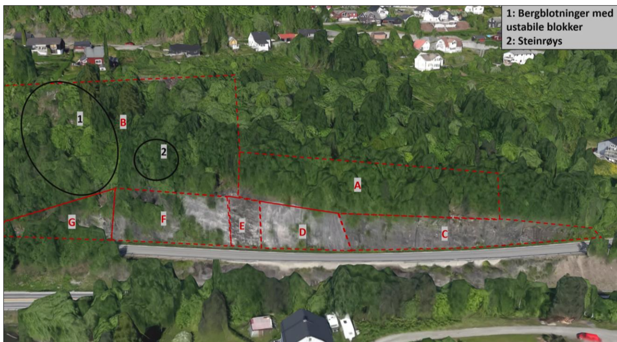
Figur 6: Oversiktsillustrasjon over dagens situasjon med inndelinger og tilhørende beskrivelser. Modifisert fra Google Earth.
