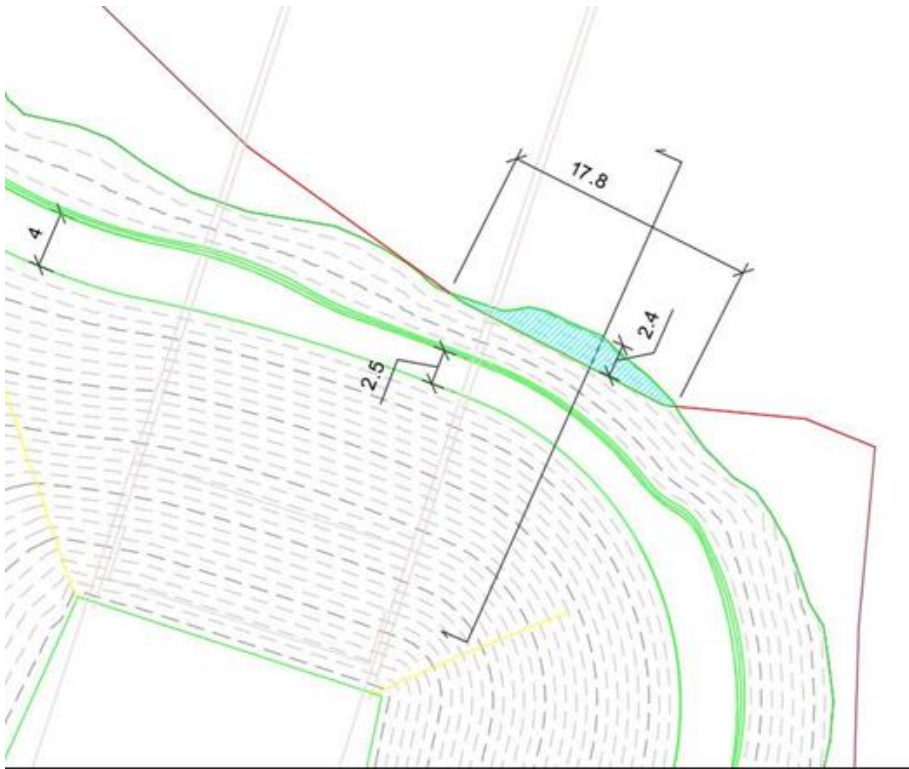
Figur 6-25. Modellert landskap ved søndre landkar for Lågen bru viser marginal utfylling i Lågen. Område markert med lyseblått viser utfylling i naturreservatet.
