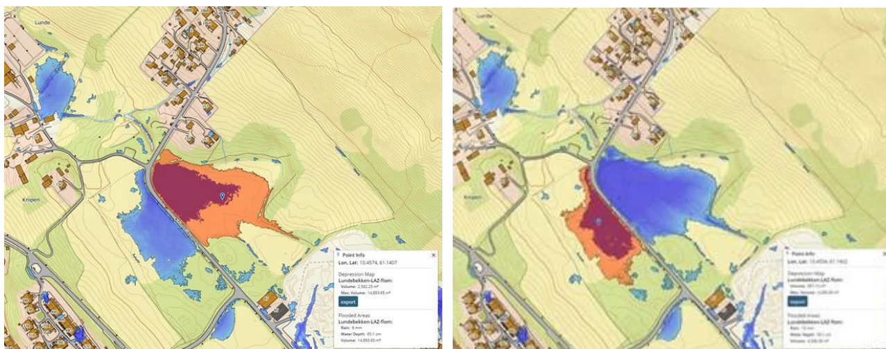
Figur 5.5 Viser potensielt fordrøyningsvolum for Lundemyra og nedstrøms Kringsjøvegen. Volumene er automatisk beregnet i analyseverktøyet Scalgo. Bilde til venstre viser Lundemyra (oransje-rødt) med et volum på ca. 15 000 m 3 og bildet til høyre viser volumet nedstrøms Kringsjøvegen på ca. 4000 m 3 .
