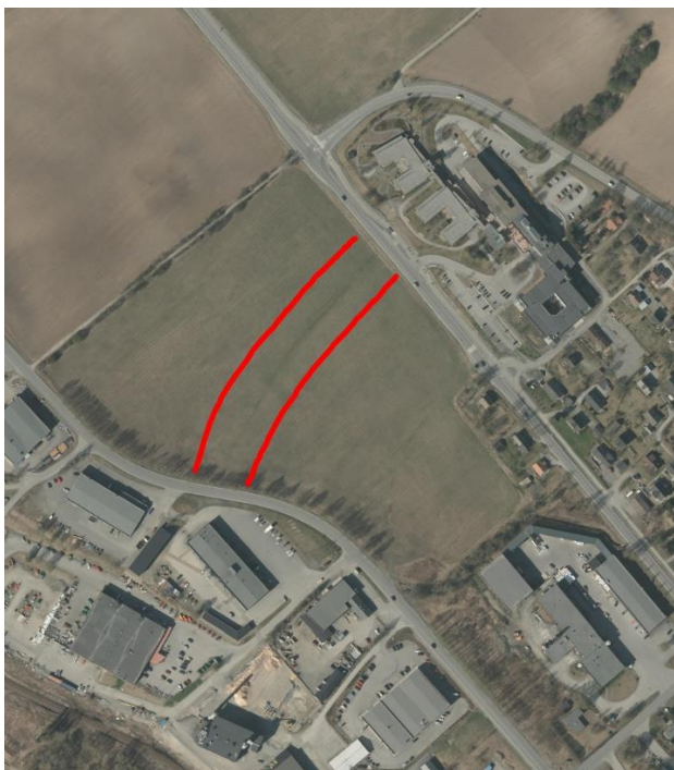
Figur 4.80 (Pkt. F11) Bekkedraget til "Skikstadbekken" går fra det grønne vegetasjonsområdet (øverst til høyre på bildet) på dyrka marka til Øvre Skikstad og under helsehuset. På flere historiske flyfoto (eks. 1881.no) kan man se antydningene hvor bekkelukkingen går videre under dyrka mark og ned til Industrigata. Etter retningen å dømme vil det være naturlig å anta at lukkingen fortsetter ned mellom Industrigata 58A. Kulvert gjennom jernbanen ligger nedenfor bygningen i Industrigata 56A (Felleskjøpet), i nedre venstre hjørnet av bildet. Nedstrøms denne er Biltema etablert i dag.
