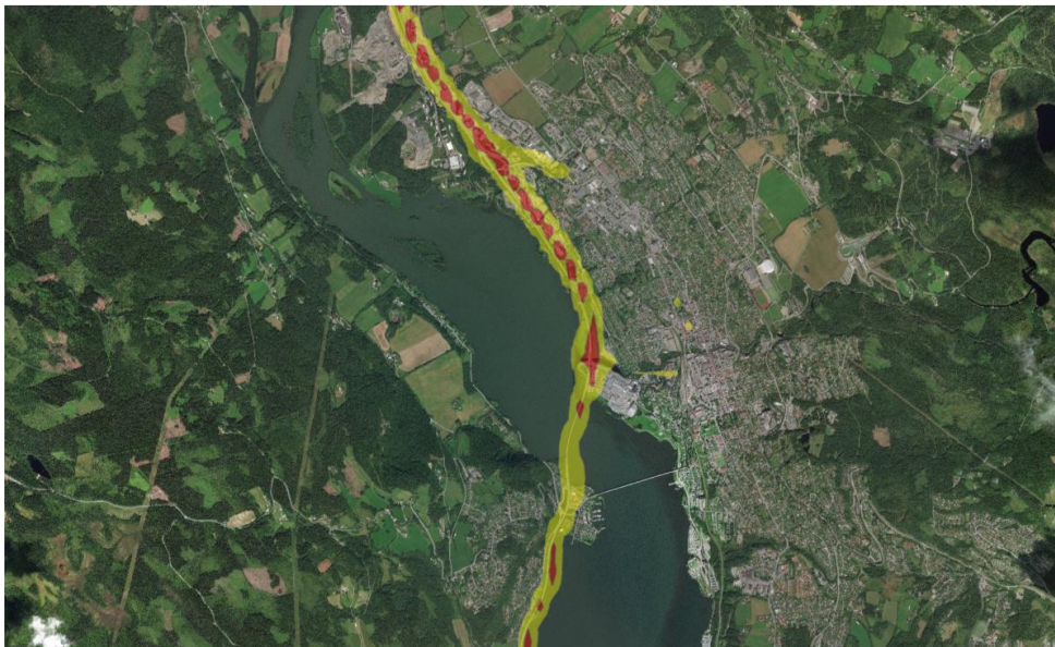
Figur 27 Luftsonekart som viser modellerte konsentrasjoner av svevestøv (PM10) og nitrogendioksid (NO2) på Lillehammer. Gul og rød sone for PM10 tilsvarer maksimum 7 overskridelser av grensene på henholdsvis 35 og 50 \mu\text{g}/\text{m}^3 , rød sone for NO2 tilsvarer overskridelse av grensen på 40 \mu\text{g}/\text{m}^3 som årsmiddel og gul sone for NO2 tilsvarer overskridelse av grensen på 40 \mu\text{g}/\text{m}^3 som vintermiddel (perioden november-april), i henhold til Retningslinje for behandling av luftkvalitet i arealplanlegging (T-1520). Kilde: Nasjonalt beregningsverktøy (NBV), trafikk 2015.
