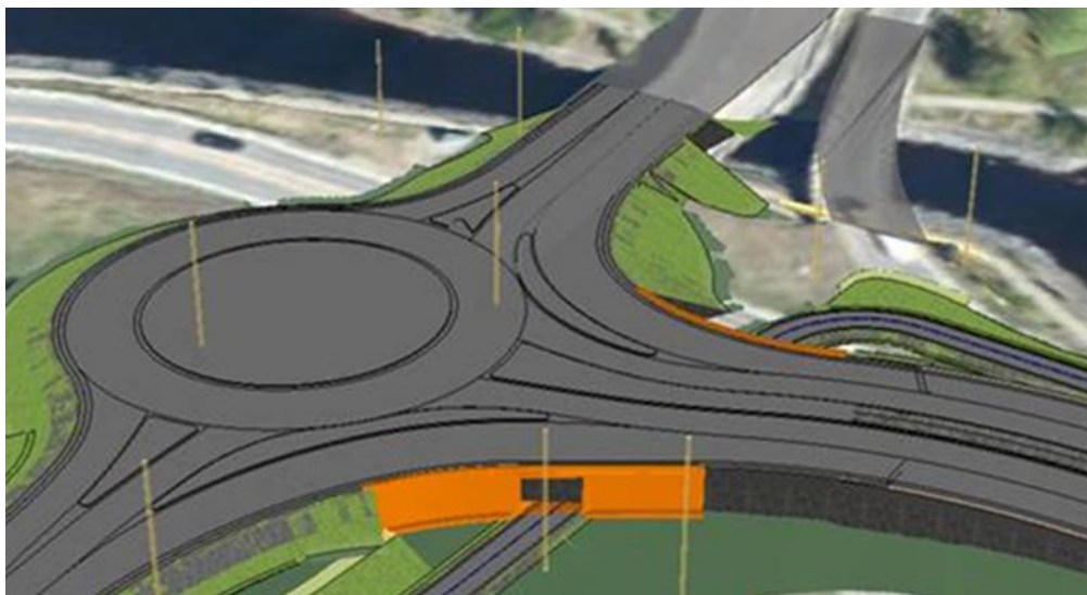
Figur 83 3D modell av ny rundkjøring på Strandtorget med ny kulvert under Mesnadalsarmen for g/s-vegen i retning Storhove.
