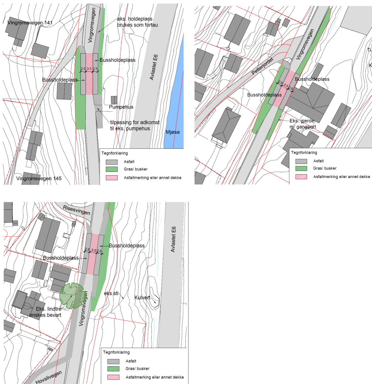
Figur 43 Illustrasjon av innsnevring og holdeplasser på strekningen. Timeglassene er like for alternativ 2A og 2C.
