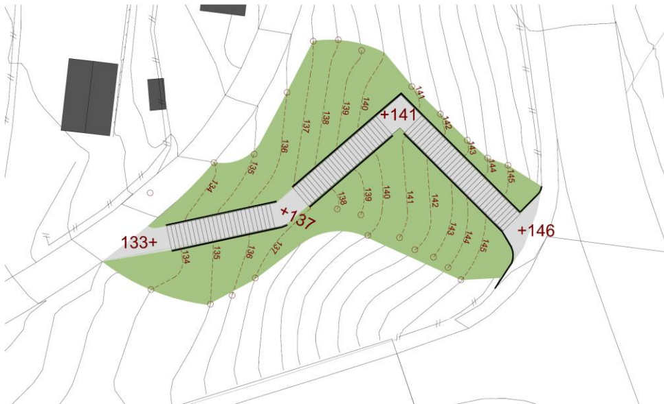
Figur 77 Illustrasjon som viser høydeforskjell mellom topp og bunn av trappa.
