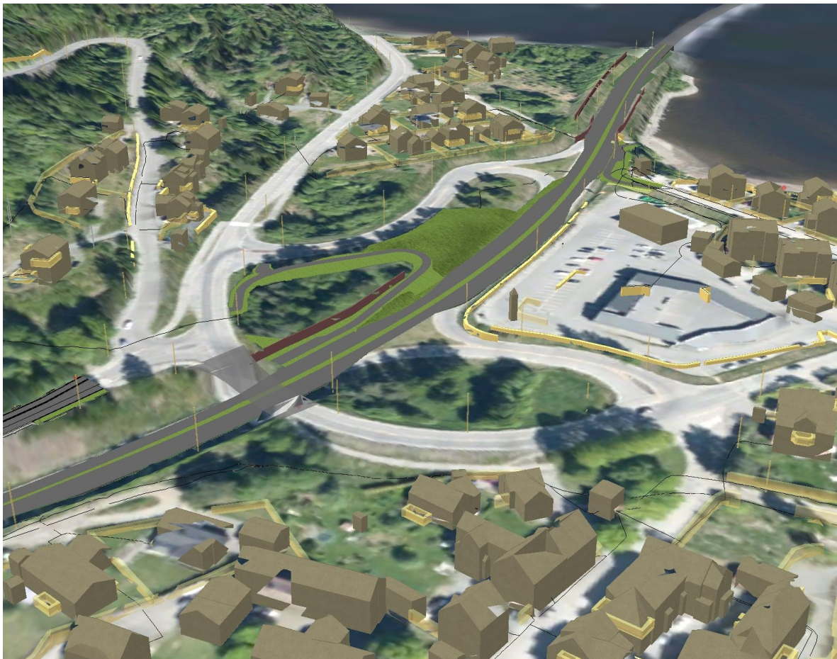
Figur 67 Støyskjerming og kollektivholdeplasser på Vingnes.
