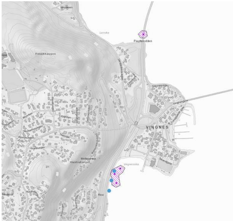
Figur 21 Statens vegvesen kvikkleirepunkter (lilla) og omtrentlig plassering av borpunkter som potensielt har truffet kvikkleire (blå), kilder: atlas.nve.no og grunnundersøkelser for E6 Vingrom-Ensby.
