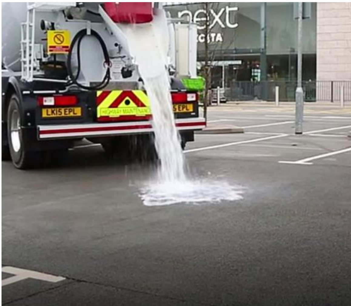
Viser testing av permeabel asfalt, der alt vannet drenerer hurtig ned i grunnen under.
