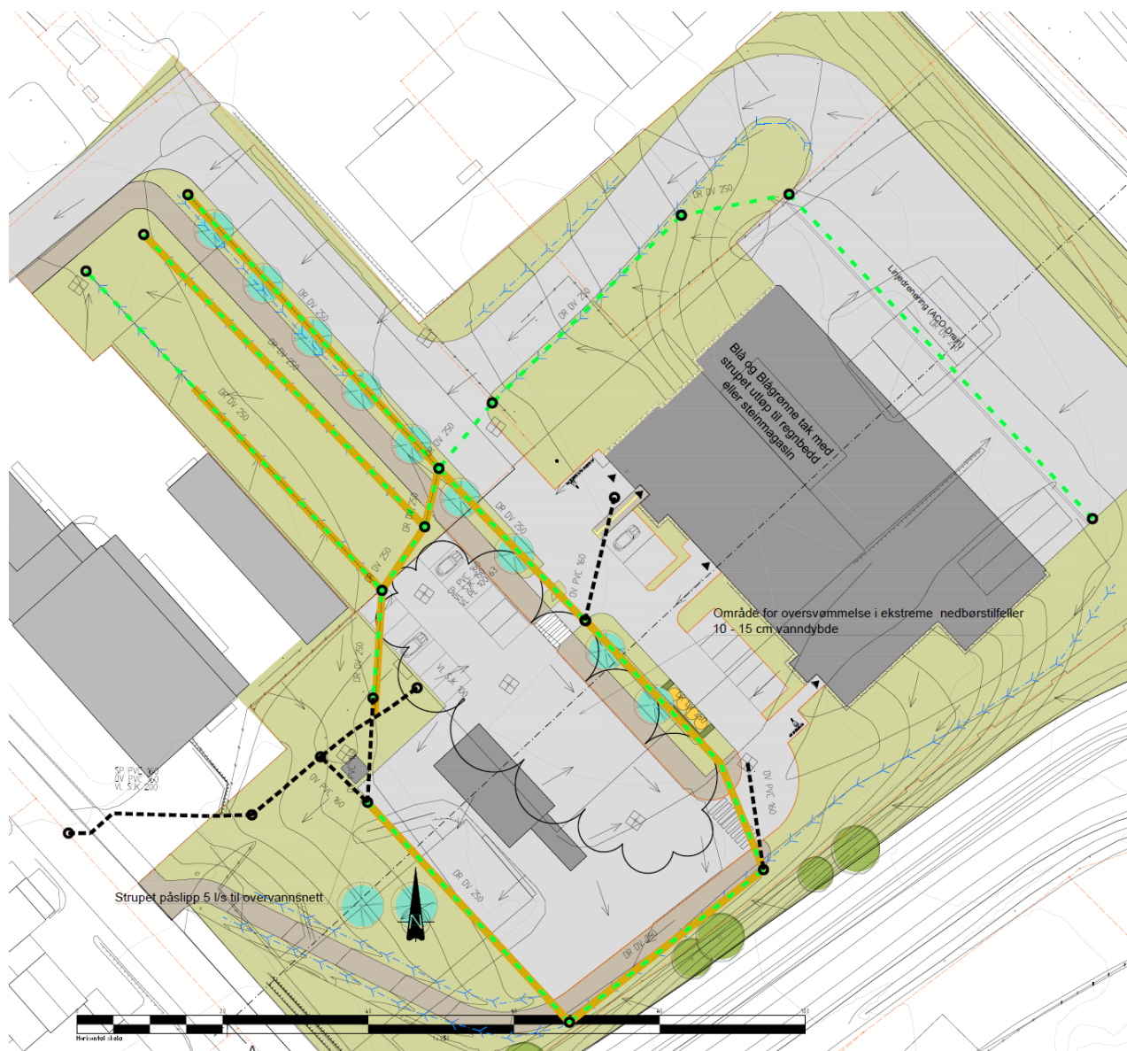
Foreløpig plan for ny brannstasjon på Lillehammer. Fordøyning på takflatene, permeable overflater på bakkenivå (bl.a. permeabel asfalt og armert grus), åpne drenerings-veier med frostfri dypdrenering og grønne forsengkninger i terrenget kombinert med vegetasjon og regnbedd.
