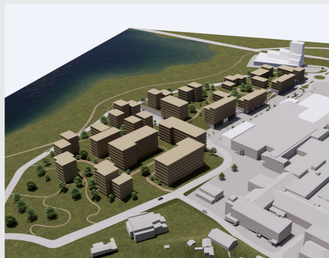
2: I dette alternativet er det subtile endringer på takformene i forhold til basisalternativet. Bygningsvolumene trappes fortsatt ned mot vannet, men de trappes også litt ned fra øst til vest, for å følge landskapet fra sentrum mot vannet.
