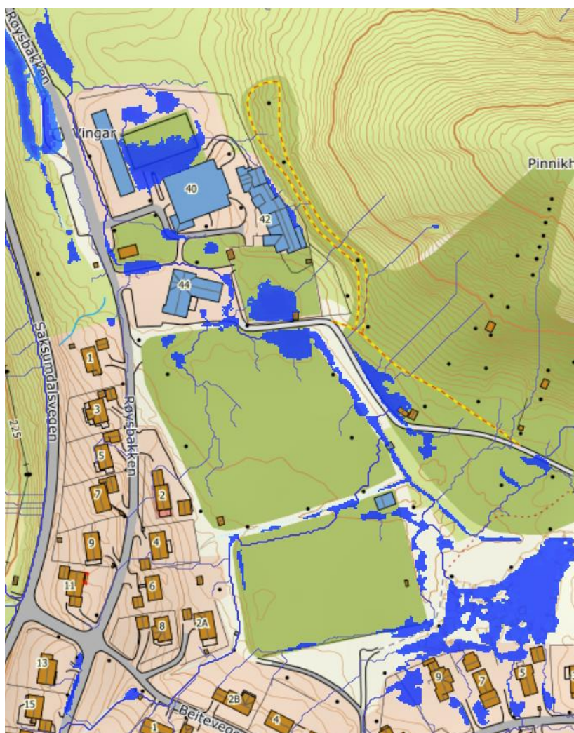
Figur 3-52: Terrenganalyse som viser hvor overvann sannsynligvis vil kunne samle seg ved store nedbørsmengder. (Utsnitt fra Scalgo Live).
