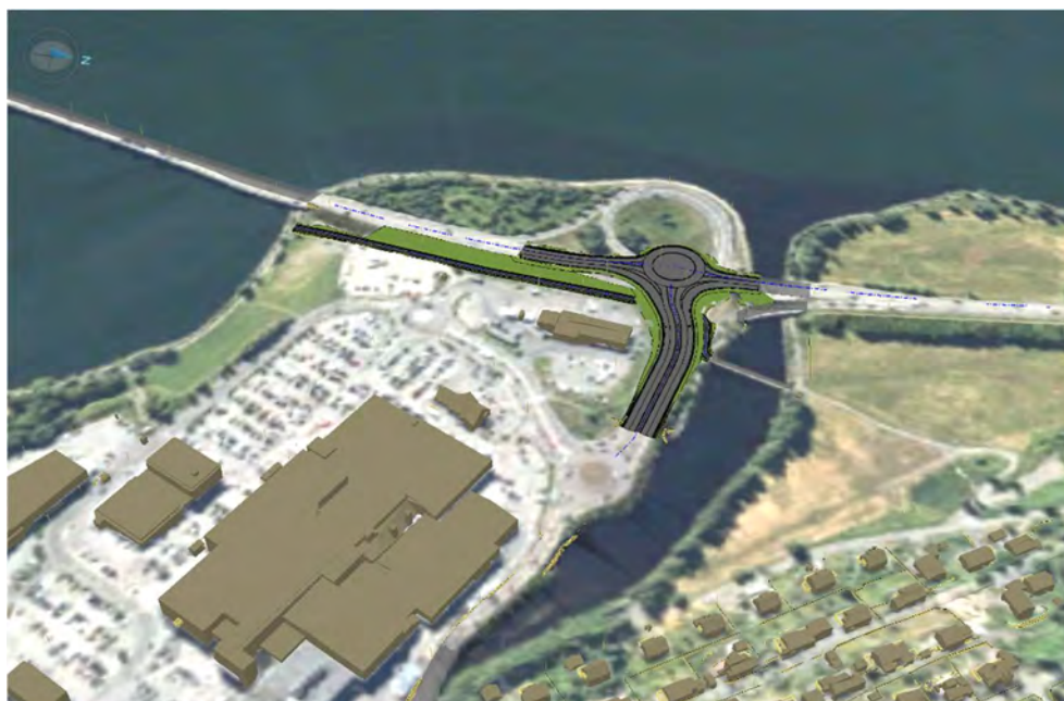
Figur 20 Rundkjøring ved Strandtorget med to sirkulerende felt.
