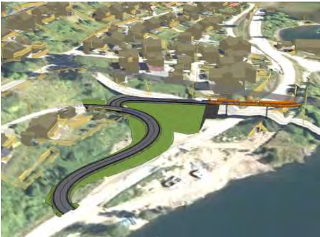
Figur 84 Skisse av løsning med g/s-vei langs nordsiden av Vingnesbrua.
