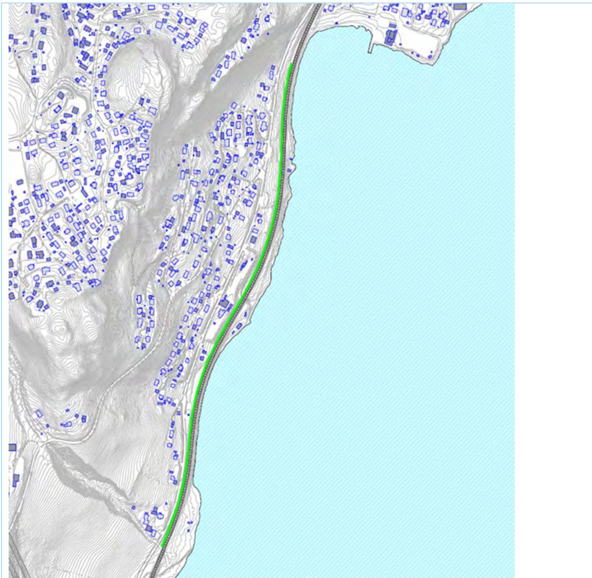
Figur 54 Plassering av støyskjermer ved Riselandet.
