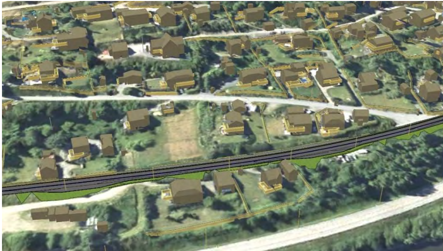
Figur 42 Illustrasjon av fortau på vestsiden av Vingromsvegen, samt møteplasser for kjøretøy.
