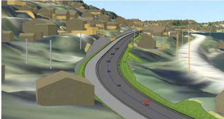
Figur 37 Illustrasjon av fortau lang vestsiden og sideforskjøvet vei.
