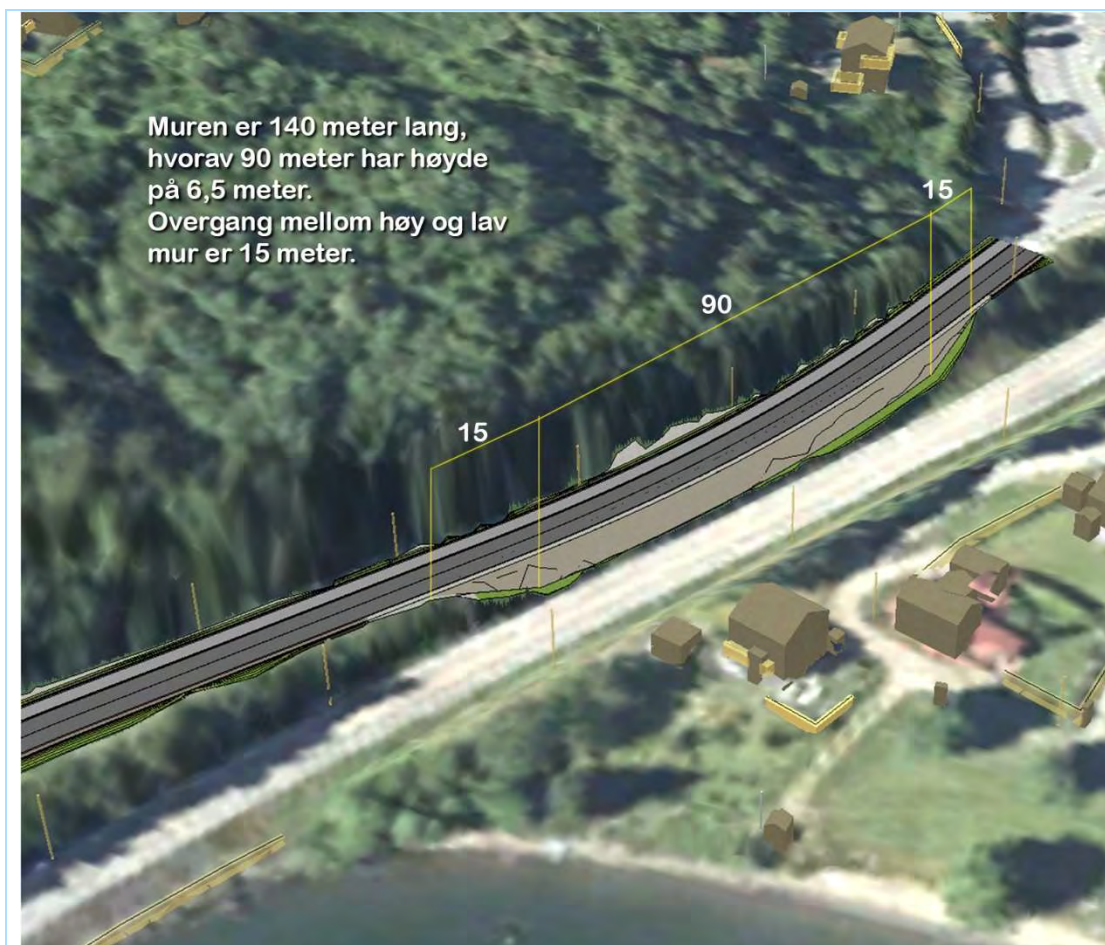
Figur 46 Skisse som viser høyde og lengde på muren ved fjellskjæringen.
