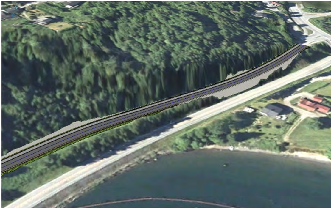
Figur 45 Justert bredde på Vingromsvegen ved fjellskjæringen.
