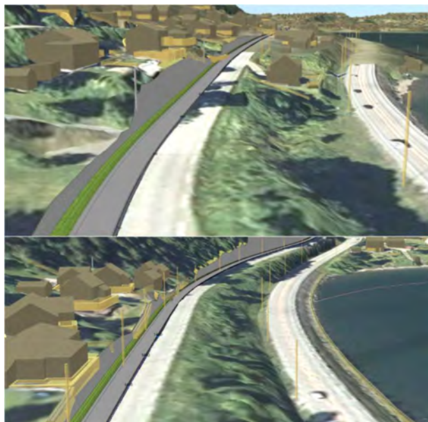
Figur 35 Illustrasjoner av fortau med mur i skjæring.
