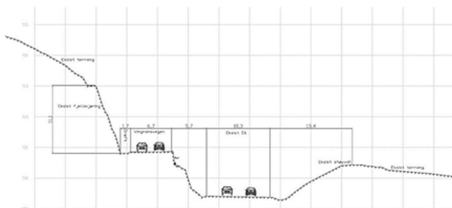
Figur 32 Snitt av dagens situasjon ved fjellskjæringen mot Vingnes
