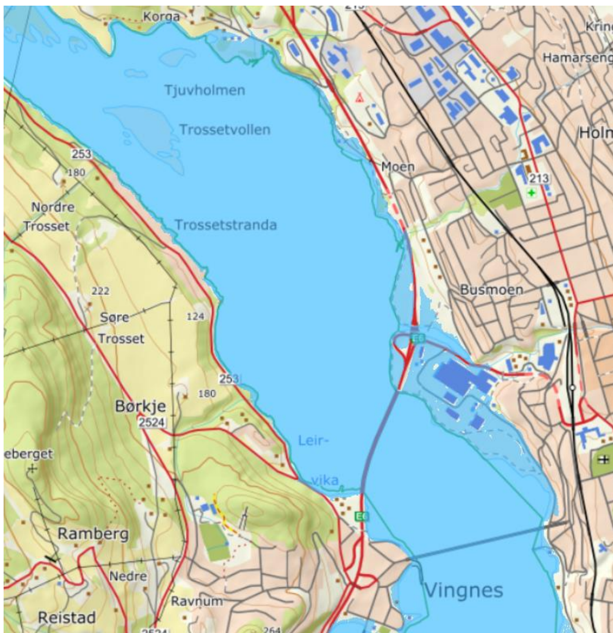
Figur 18. Flomsoner Mjøsa ved Lillehammer bru forutsatt en 200 års flomvannstand på kote 126,62 i Mjøsa.
