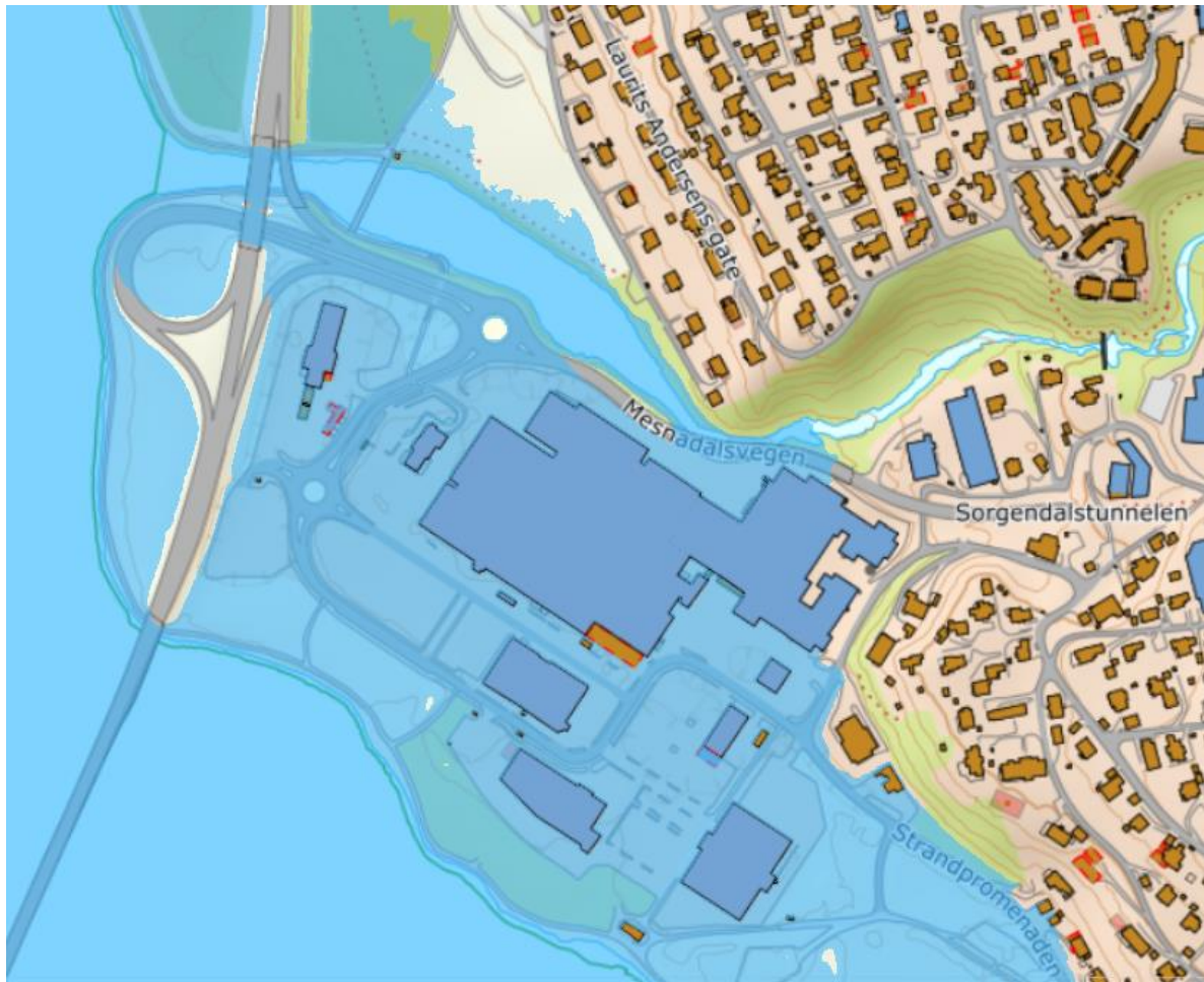
Figur 19. Grove flomsone ved Strandtorget, flomvannstand 126,7 moh i Mesna. Kilde: Scalgo.
