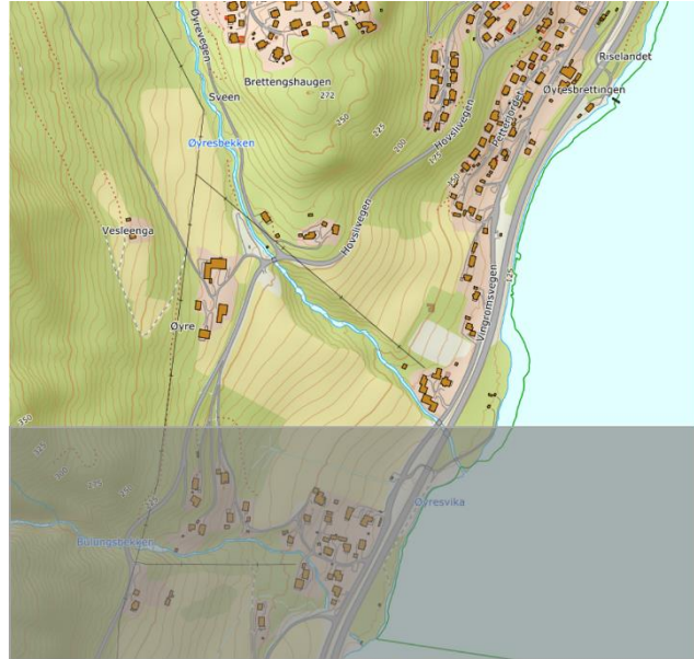
Figur 2 Område markert med grått i Øyresvika blir utsatt for støy fra ny E6 og er ikke skjermet i disse beregningene.
