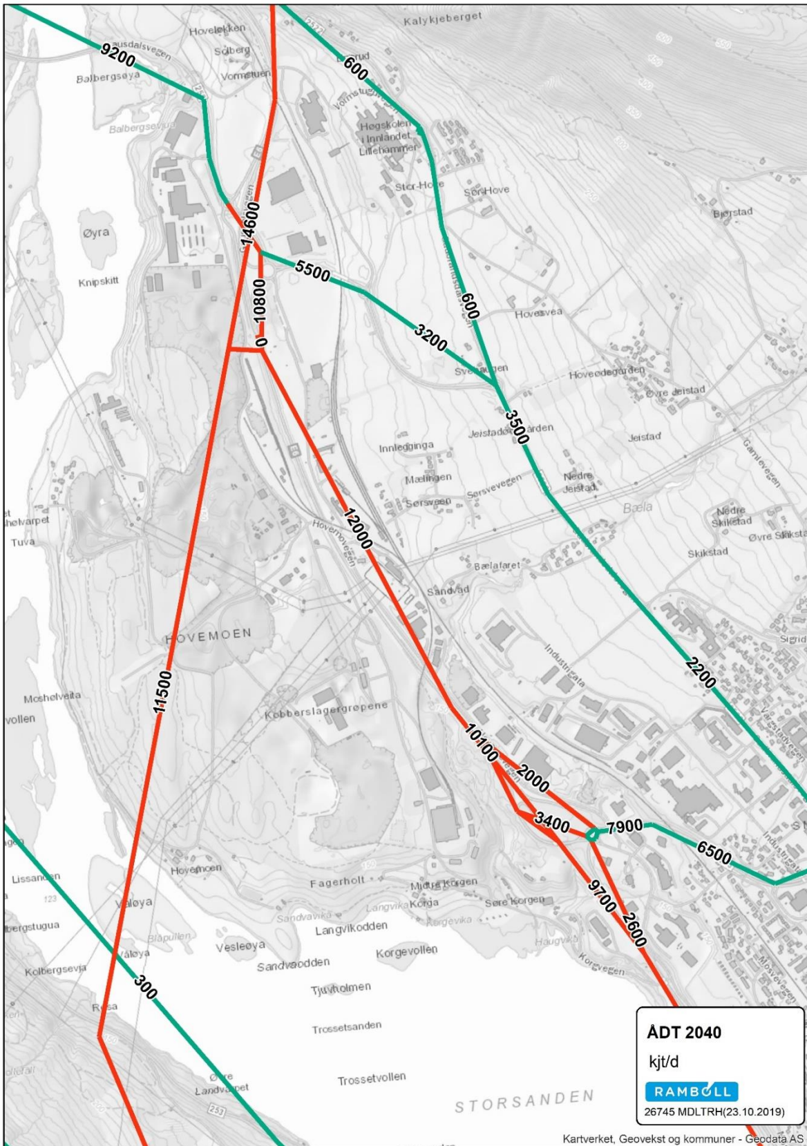
Figur 14 Avlastet E6 - Hovemoen, detaljert ÅDT 2040 (RTM)
