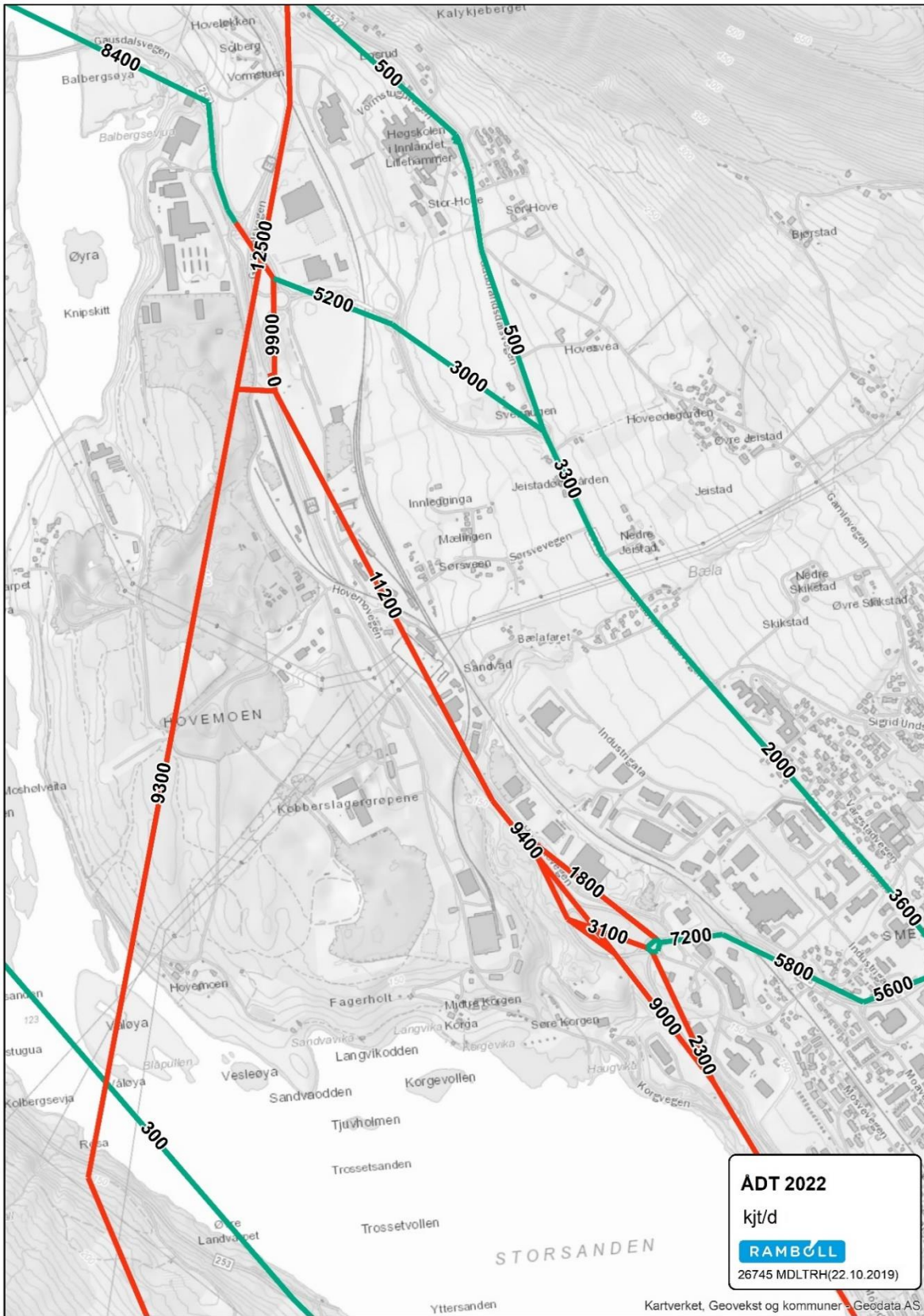
Figur 9 Avlastet E6 - Hovemoen, detaljert ÅDT 2022 (RTM)
