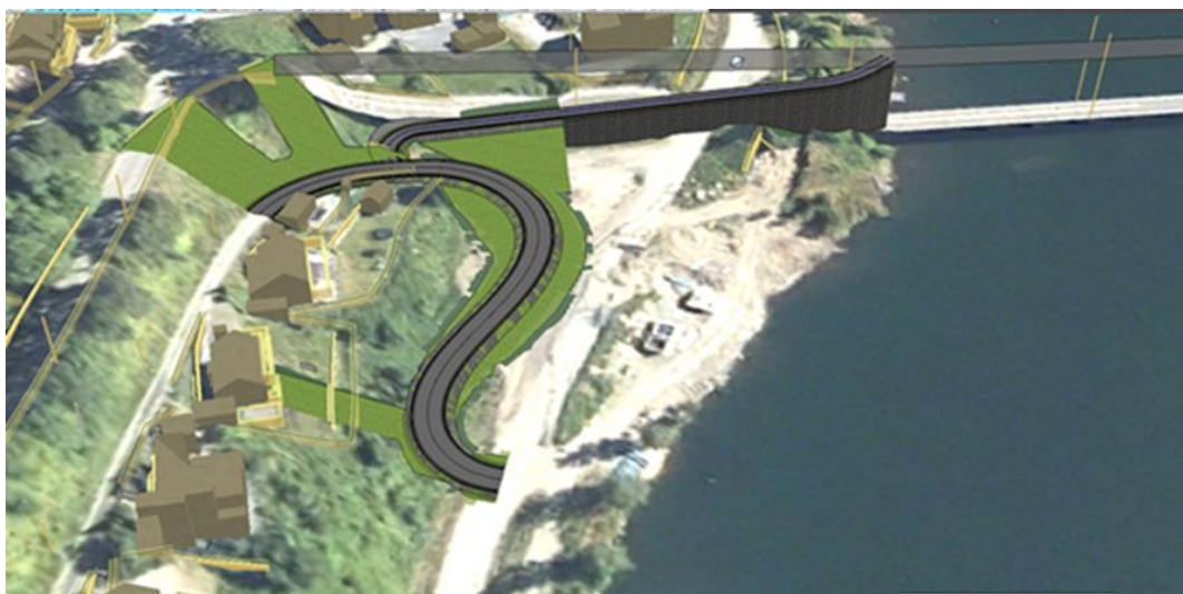
Figur 4.5: Frittstående g/s-bru og fylling
