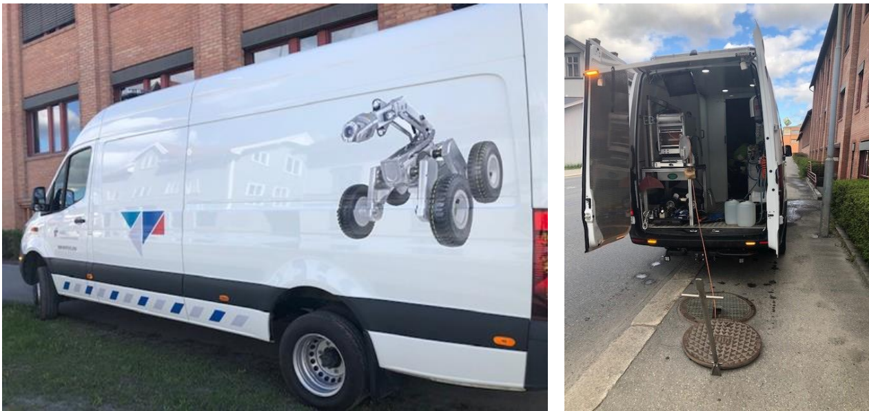
Figur 38 Kamerabil med utstyr for TV-inspeksjoner er både et nødvendig og svært nyttig arbeidsverktøy
