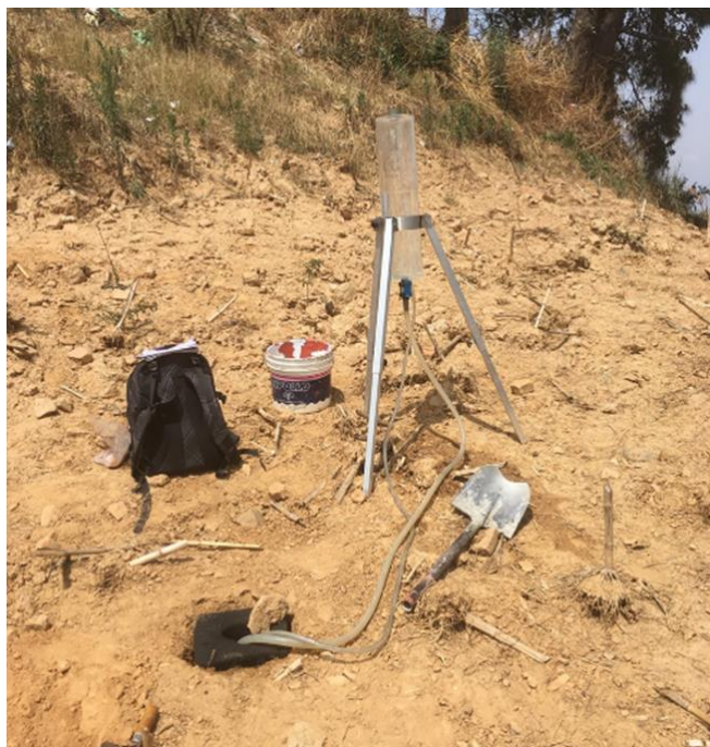
Figur 54 Grunnundersøkelser i felt for å kartlegge jordmassenes evne til å motta avløpsvann (foto: Øystein Fure Mæhlum) og skisse av infiltrometer (Norsk Vann, rapport 178/2010)
