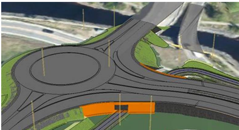
Figur 80 3D modell av ny rundkjøring på Strandtorget med ny kulvert under Mesnadalsarmen for g/s-vegen i retning Storhove.
