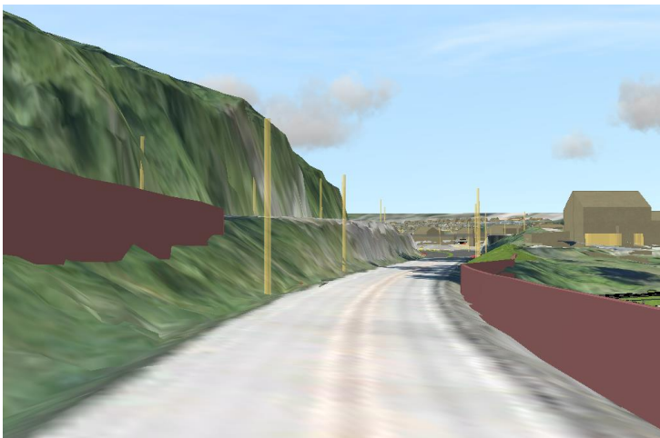
Figur 11 Planforslag til 1.g høring - skjermhøyde opptil 4 meter på vestre side (utklipp fra modell).
