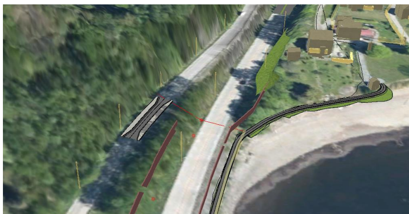
Figur 48 Supplert innsnevring ved fjellskjæringen med gangareal.
