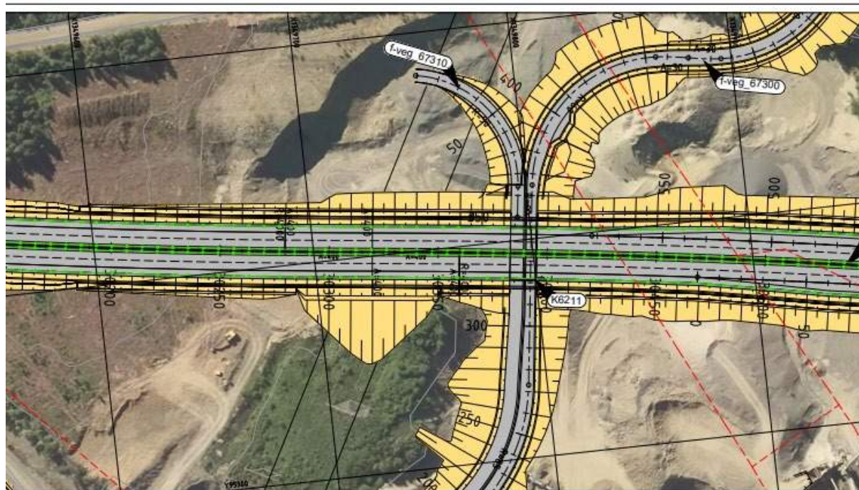
Figur 3 - Arbeid under og nære ved Statnetts 300 kV ledninger mellom Fåberg og Vinstra. Nærføring og skråningsutslag mot Statnetts mast 230 og 295 må avklares.
