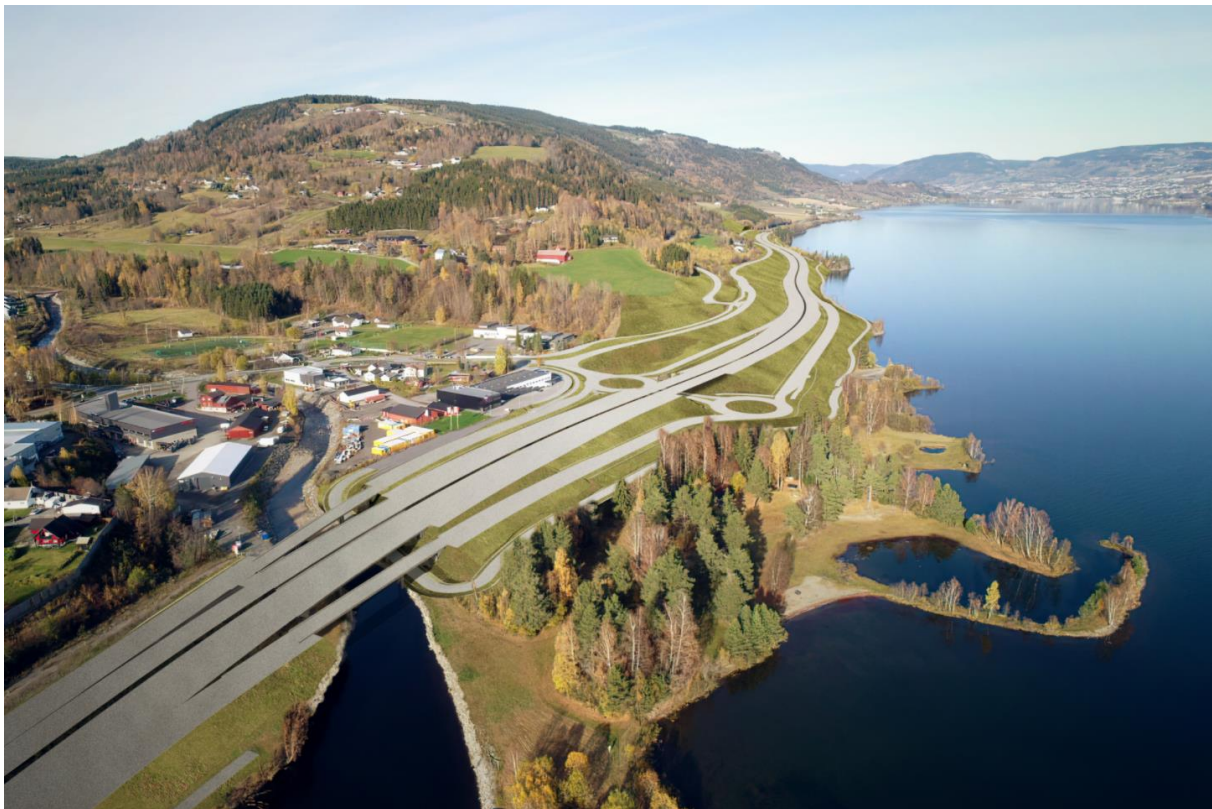
Figur 5-58 Illustrasjon av kryss midt med friområde Vigromdammen til høyre. E6 ligger høyere enn dagens E6 og nærmene Mjøsa. Ny E6 med ramper og rundkjøring beslaglegger arealer mot sentrum. Tursti er ikke lagt inn på illustrasjonen.
