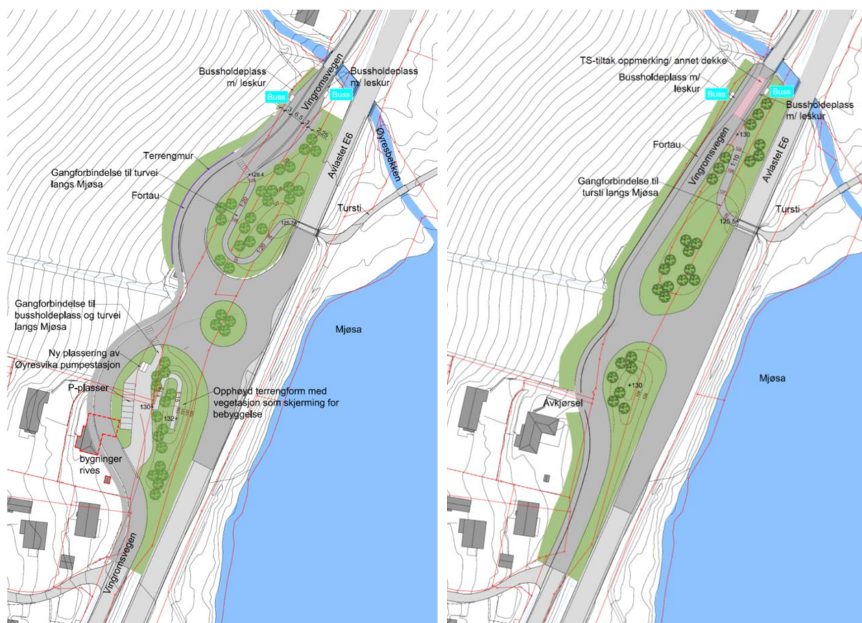
Figur 13: Utklipp fra Novapoint-modell av tiltak 2, kryss ved Øyresvika, primæralternativet: 4-armet rundkjøring på venstre side, reguleringsalternativet: T-kryss på høyre.
