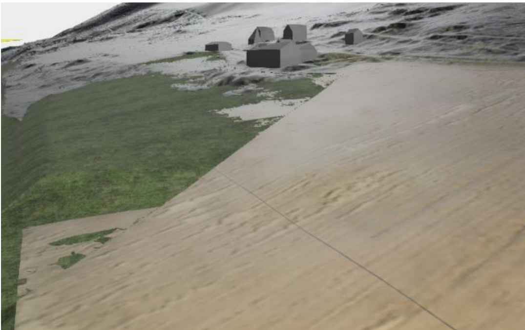
Figur 5-24. Løsningen forutsetter en heving av terrenget på innsiden av Fylkesvegen. Dette muliggjør en oppdyrking av arealet opp mot gården. Det hevede arealet får mindre helning enn tilstøtende areal.
