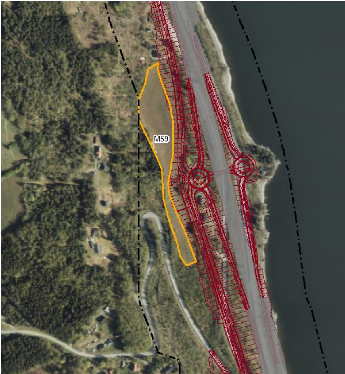
Figur 5-33. Mulig forbedringsareal på gården Nedre Rindal som skal benyttes som mellomlager i forbindelse med anleggsarbeidene.
