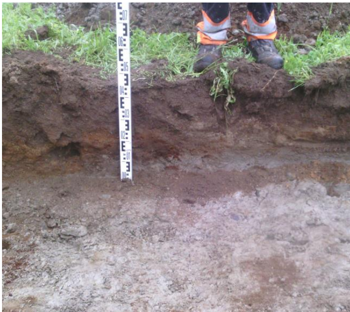
Figur 2-8. jordprofil tatt på gården Huskelhus nordre. Tykkelse A-sjikt 20 cm, B-sjikt omkring 15 cm. Svært tett leire under A- og B-sjikt som gjør at vann i liten grad trenger ned.
