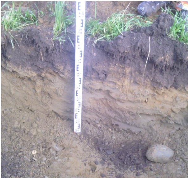
Figur 2-21. Jordprofil fra gården Stor Hove. Tykkelse A-sjikt 25 cm. B-sjiktet framstår med svakt utviklet jordstruktur.
