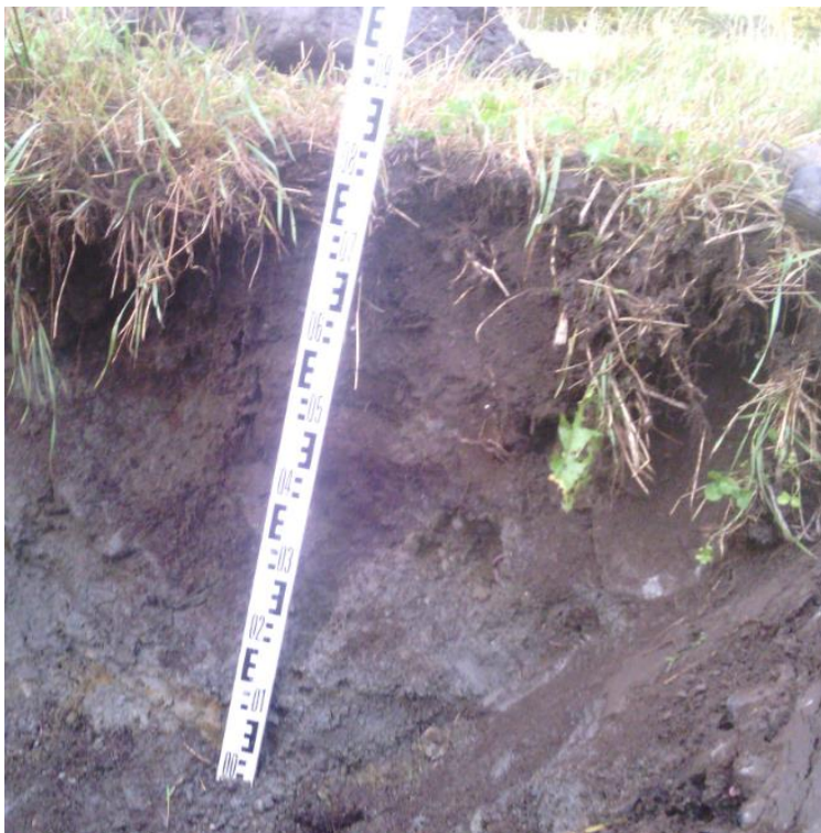
Figur 2-14. Jordprofil fra gården Bjørnstad nordre (vestsiden av E6). Tykkelse A-sjikt 35-40 cm. B-sjikt vurderes som lite utviklet med en overgang mot fastere og vannholdig leire.
