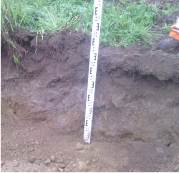
Figur 2-15. Jordprofil fra gården Sveen. Tykkelse A-sjikt 25 cm, E-sjikt 30 cm. Vurderes som det er noe jernutfelling i B-sjiktet under E-sjiktet. Relativt mye grus og stein i profilet. Podsoljordmonn.
