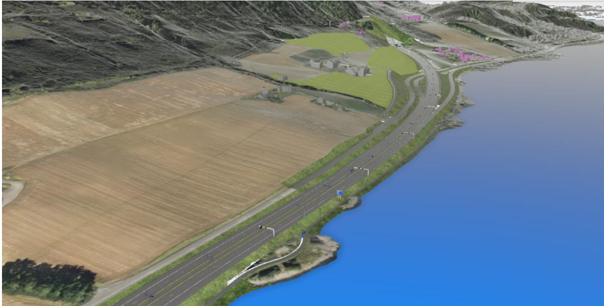
Figur 2-8. Veilinjens mellom Hov og Øyresvika, med kombinert tursti og driftsvei strandsonen.
