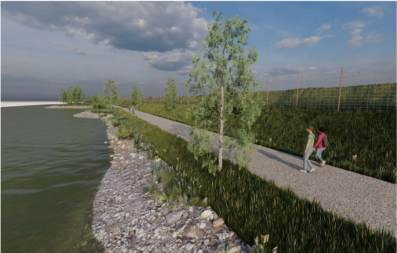
Figur 5. Sjøbunnen og strandsonen reetableres med sand, grus og stein fra områdene som blir berørt av utfyllinger.
