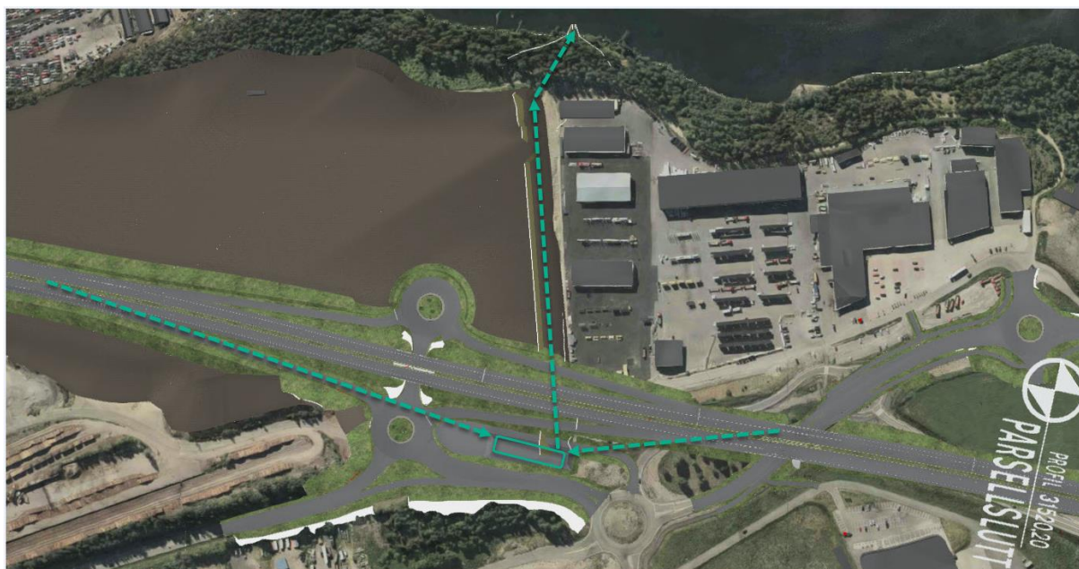
Figur 8-2. Prinsipp for oppsamling av overvann fra vei til basseng på Storhove.
