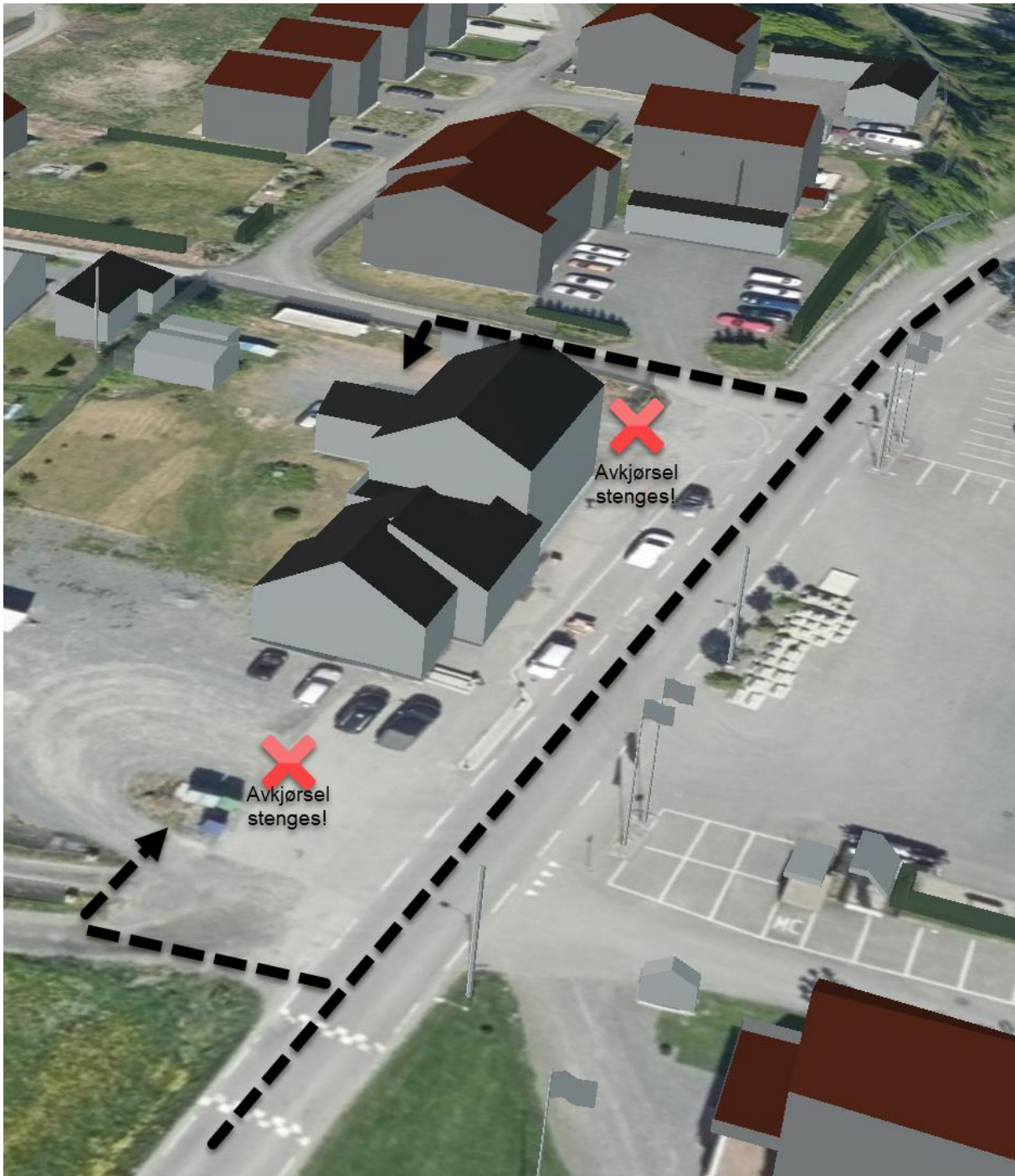
Illustrasjon 24: Tiltent vegløsning for området er 2 av 4 avkjøringer inn til området redusert og optimaliseres.
