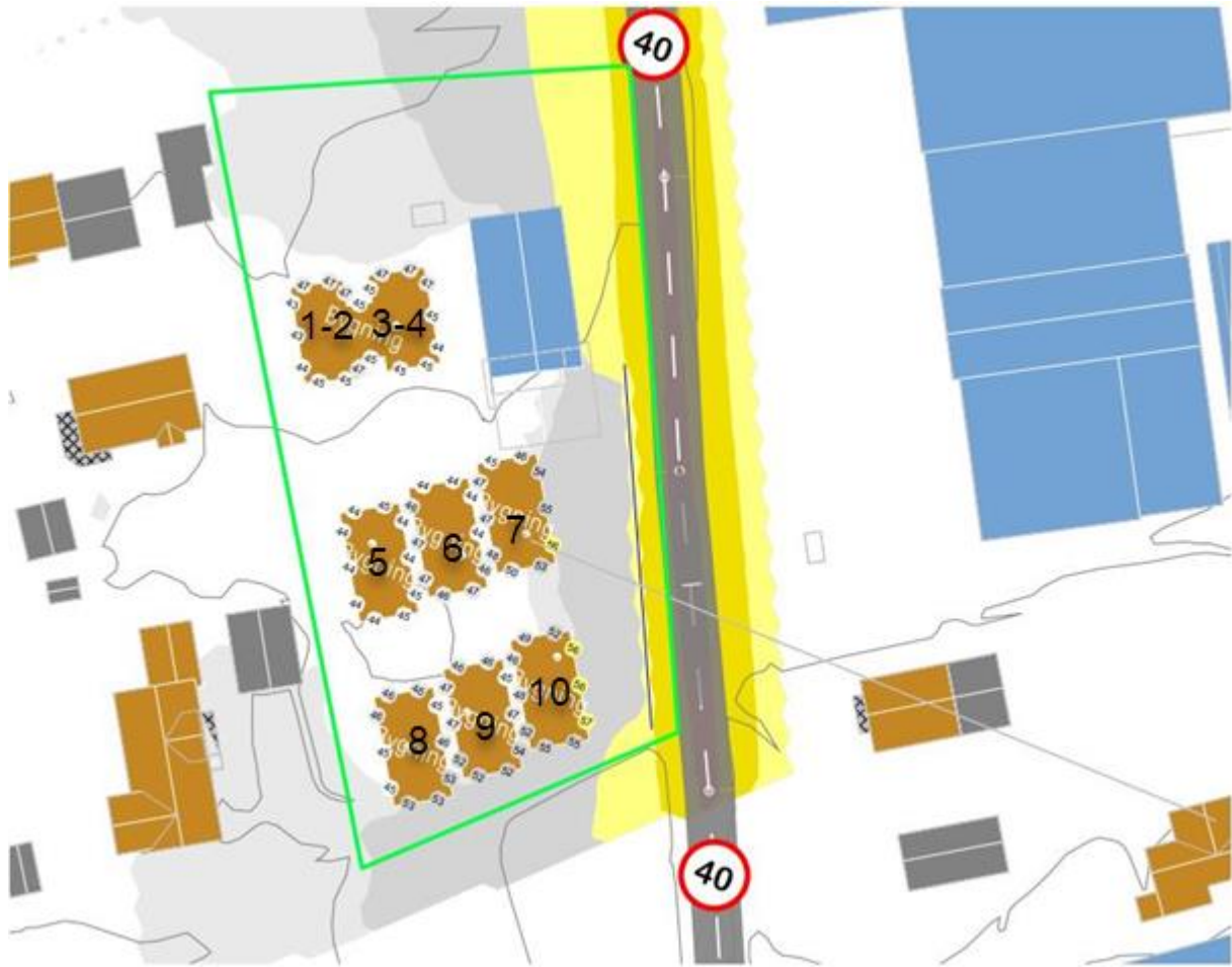
Illustrasjon: Viser alternativt støykart med forslag til støyskjerm mot vei. Støyskjerm er modellet til 1,5 meters høyde med en minimum tetthet på 10 kg/m 2 .
